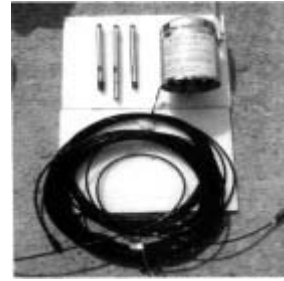
2) 센서, RTU 전원공급장치, 케이블 준비
