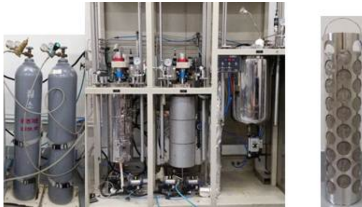
그림 5.1. 자체 개발 Subcritical Extraction Pilot Plant System (R-401) 장비(왼쪽) 및 cell (오른쪽)
