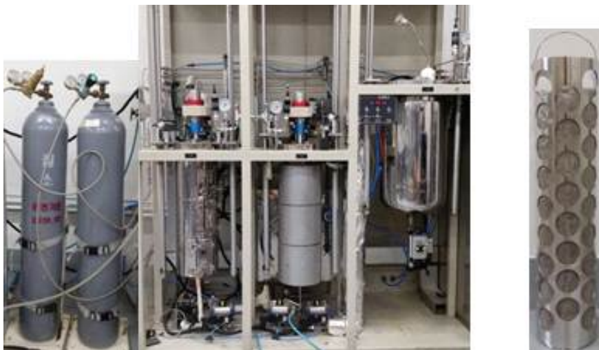
그림 42.1. 자체 개발 Subcritical Extraction Pilot Plant System (R-401) 장비(왼쪽) 및 cell (오른쪽)
