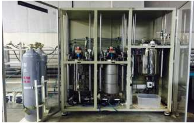
그림 3. Pilot-scale 아임계수 추출 장비(자체 제작 기기)
