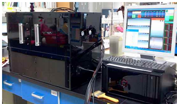
[그림 7] 생식과 고춧가루 살균을 위한 lab-scale 광펄스 장치
