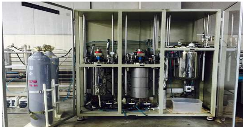
그림 3.2. Pilot-scale 아임계수 추출 장비(자체 제작 기기)
