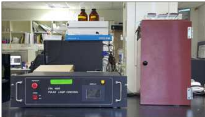
그림 4. Lab-scale 광펄스 살균 시스템 controller(자체 제작 기기)
