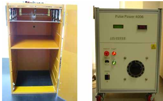
[그림 6] 라면스프와 생식 살균을 위한 lab-scale 광펄스 장치
