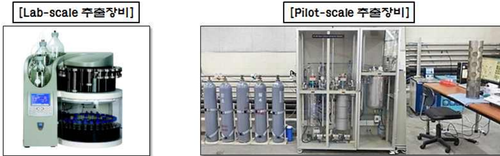
그림 5. 본 연구진이 보유하고 있는 아임계수 추출장치
