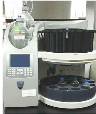
그림 3.1. Lab-scale 아임계수 추출 장비(Dionex Accelerated Solvent Extractor, ASE Model 100)
