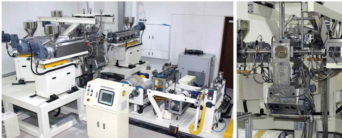
<그림 28 Polymer/zeolite 13X 복합소재 대면적 필름을 제조하기 위한 pilot 생산 라인 장비>
