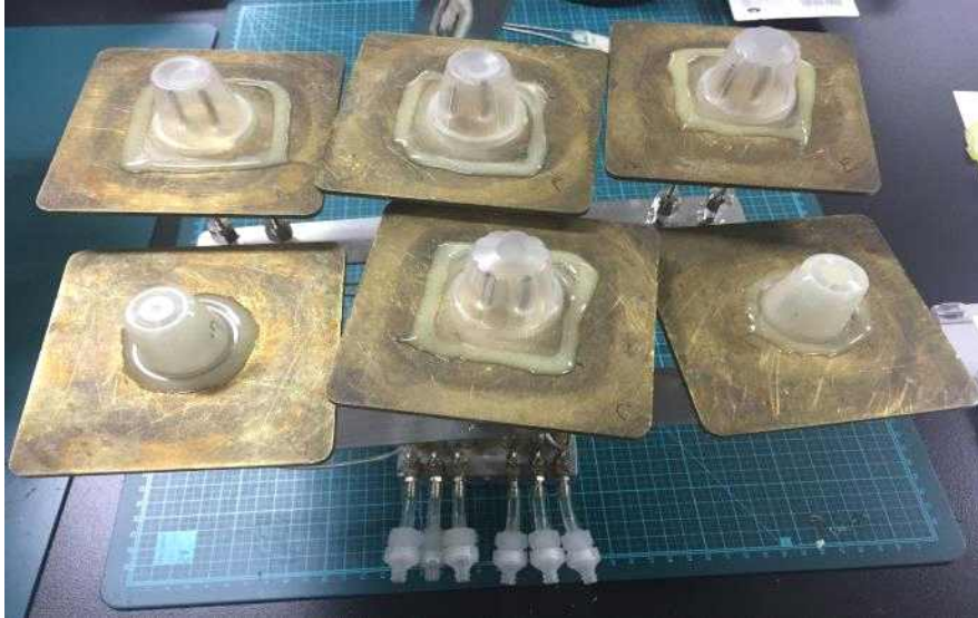
투과도 분석을 위한 Sample holder 및 분석 장비
