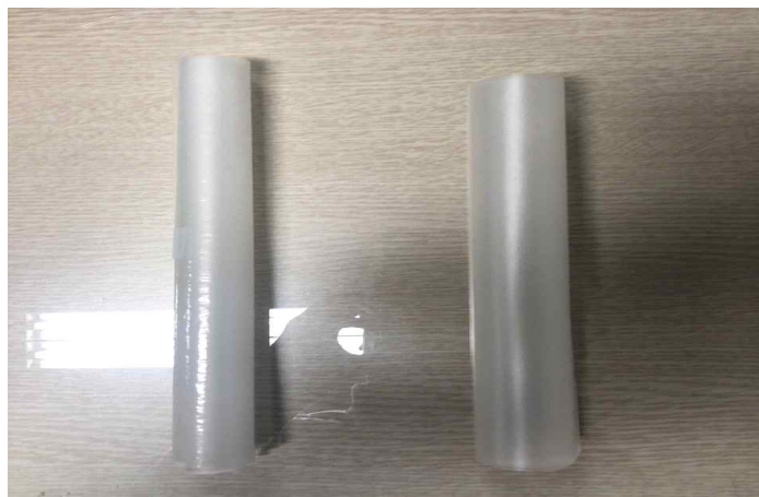
<그림 30 Pilot 생산 라인으로 제작한 Polymer/zeolite 13X 복합소재 대면적 필름의 시제품; (좌) LDPE/zeolite 13X, (우) PP/zeolite 13X>
