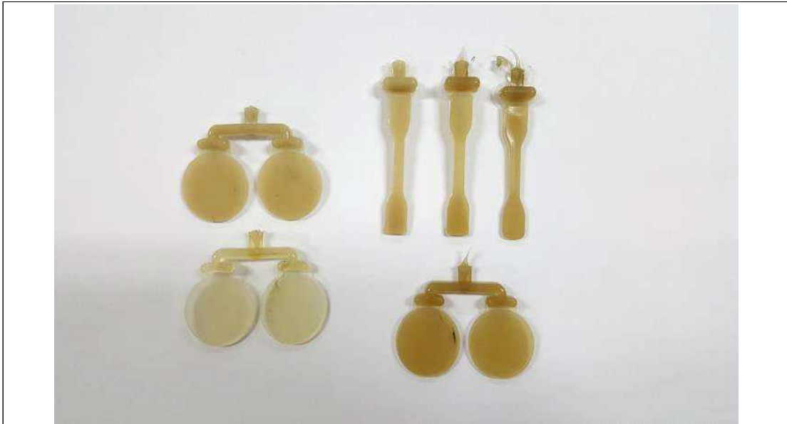
<사진 16 Rheometer와 UTM 분석용 Disk 와 Dog bone type 시편>
