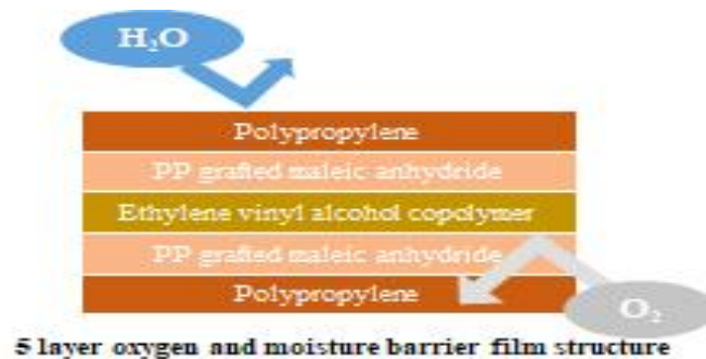
<그림 10 산소 및 수분 차단성이 우수한 다층구조 시트 구조>
