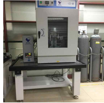
유기화합물의 흡착 및 수증기 흡습 분석 기기
