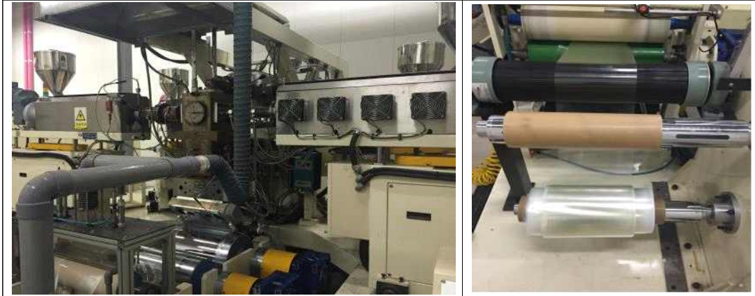
<사진 19 Multi-layer T-die extrusion film production line (왼쪽), 필름 시제품 제작 과정 (오른쪽)>
