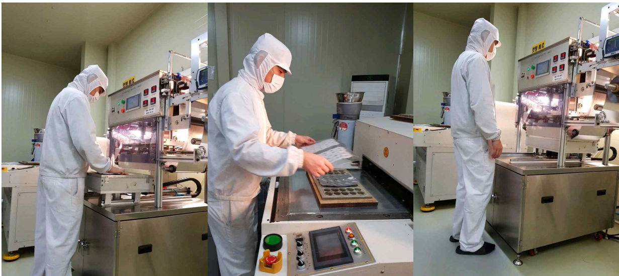
<그림 33 캡슐과 lid 필름을 열접착 공정을 통해 시제품을 생산 과정>
