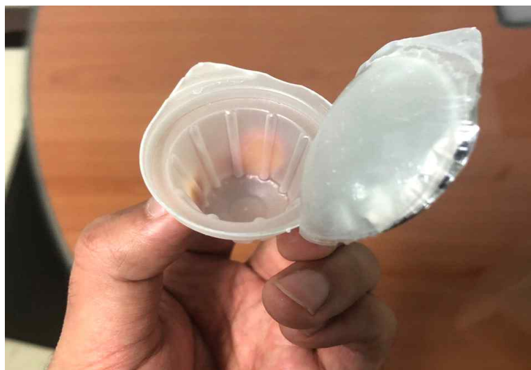
<그림 34 캡슐과 lid 필름을 열접착 공정을 통해 생산된 시제품 사진; (상) 완성된 시제품을 위에서 관찰한 모습, (중) 완성된 시제품을 측면에서 관찰한 모습, (하) 완성된 시제품을 캡슐과 lid 필름으로 박리한 모습>
