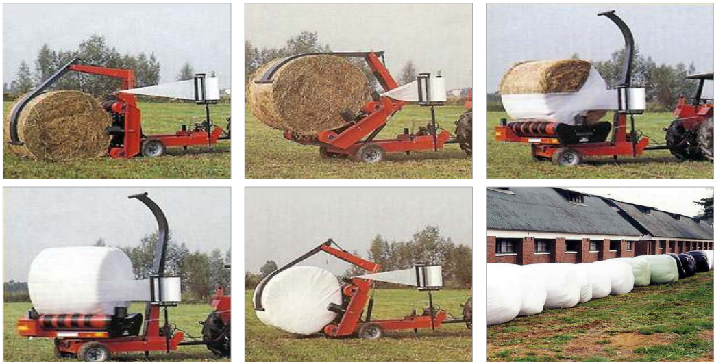
비닐 피복기 작업전경 및 저장
