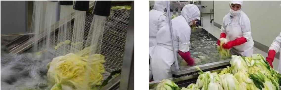
평가대상기술은 절임배추의 세척수 관리 시스템 및 세척수 관리 방법에 관한 것이다. 구체적으로 절임배추의 세척수조에 세척수를 공급하는 세척수 공급배관라인, 세척수를 추출하는 세척수 추출배관라인, 세척수조로부터 추출한 세척수가 집수되는 집수조를 포함하며 절임배추 세척 중 수조 내 세척수의 탁도가 설정값을 초과할 경우 세척수조에 세척수를 추가 공급하여 세척수의 탁도를 설정 값 이하로 관리하는 것을 특징으로 하는 기술이다(<그림 1-3> 참조).
