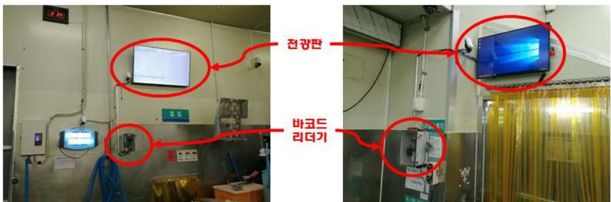
[그림 83] 공정현황 시스템 현장 설치
