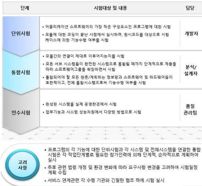
[그림 144] 개발 시스템의 테스트 절차
