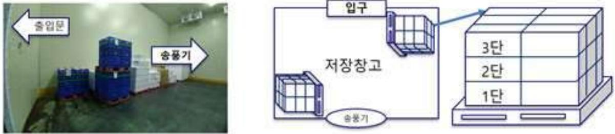
[그림 28] 숙성창고 내 온도계 설치 위치 및 김치 저장 위치 설정
