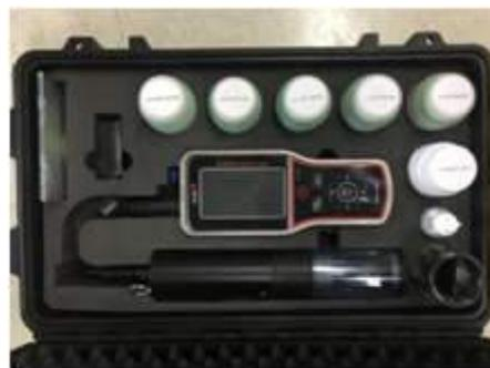
[그림 64] 선정한 복합센서(pH, 온도, 염도 측정) 제품
