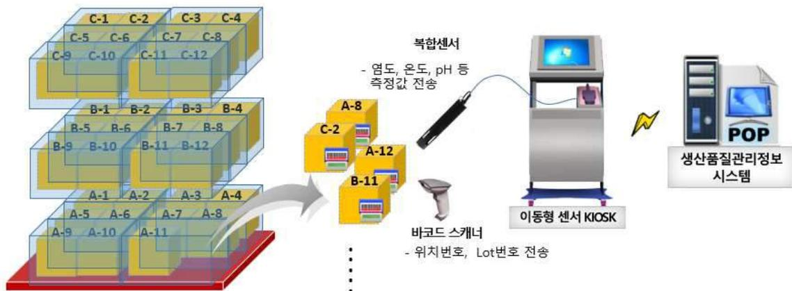
[그림 133] 여러 위치 김치의 온도, 염도, pH 값 등 다양한 정보 측정
