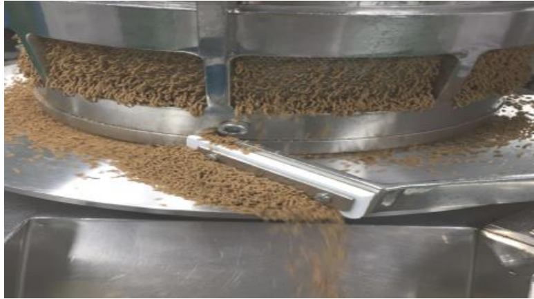
그림 17. 역회전 과립기에 의한 분말과립 제조 (정제수 40% 첨가 원료)
