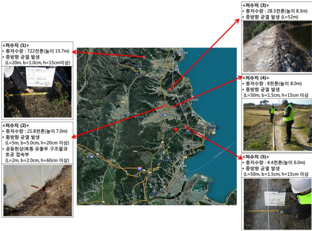
<그림 4-40> 포항지진 농업용저수지 제방 피해(한국농어촌공사, 2017)
