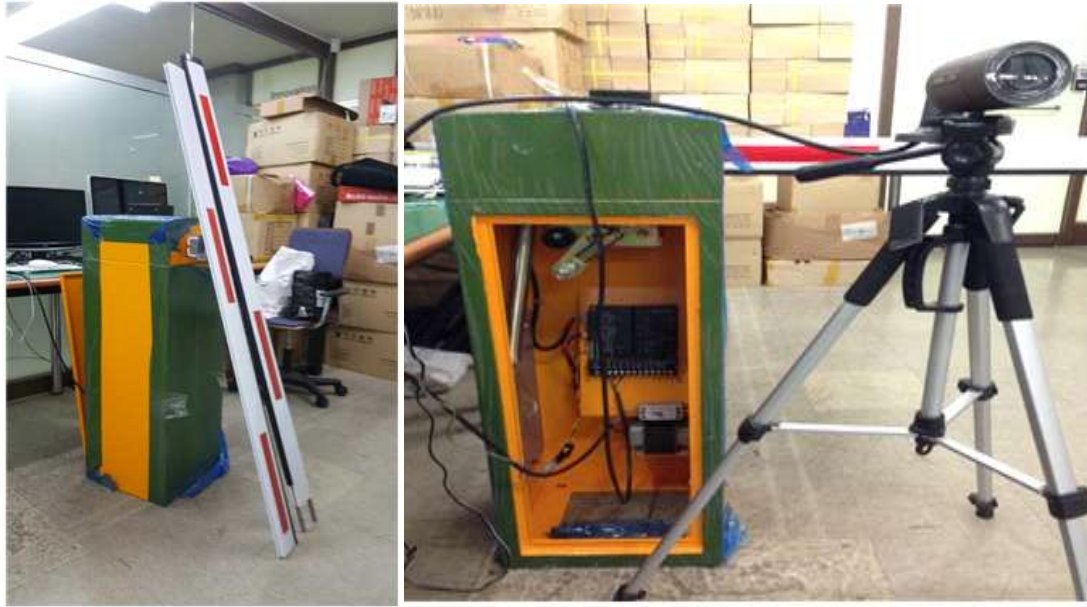
그림 35. 차량 개폐기의 제작 및 정면 모습
