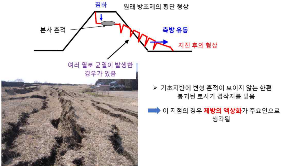
그림 2.9 사면 바닥부 축방 유동 형
