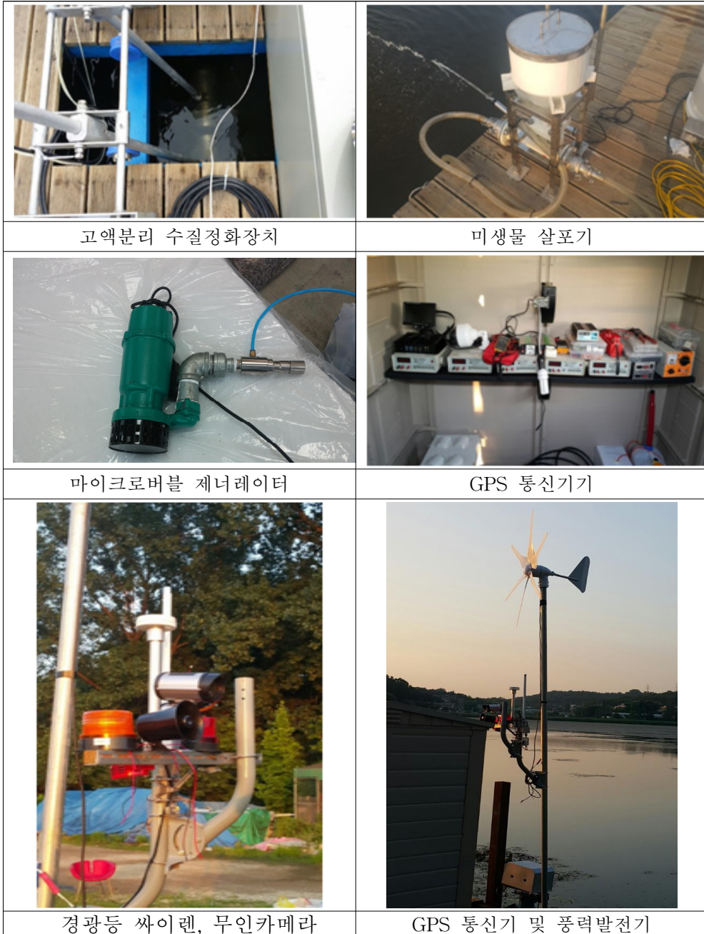
<그림 4-68> 무인항법 이동식 수질정화선 구성 장치
