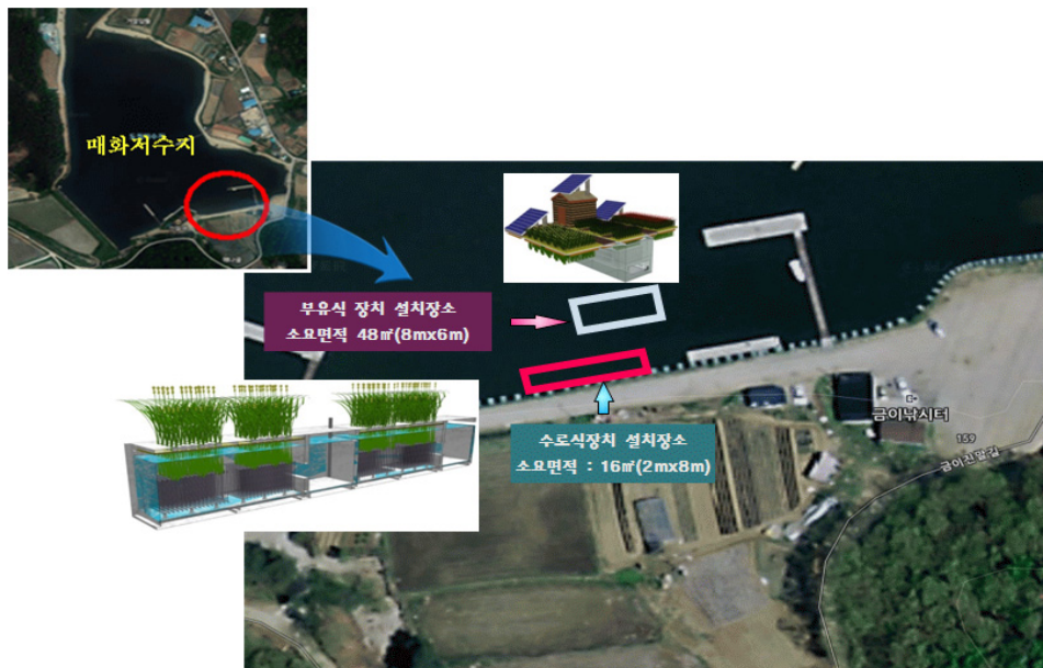
<그림 4-27> 접촉산화수로 및 접촉산화부도 설치 위치
