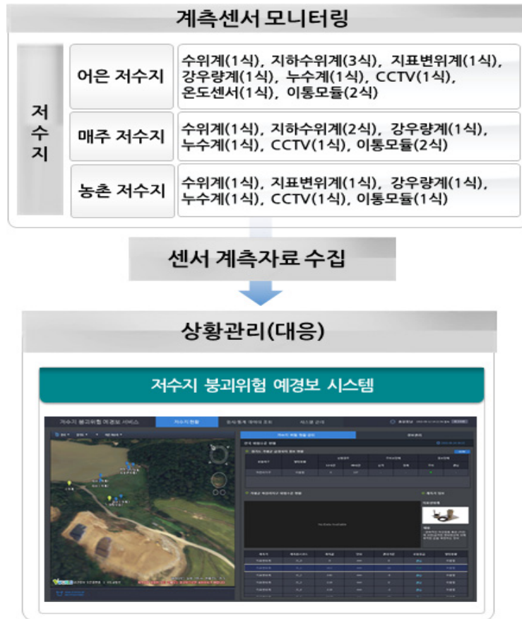
<그림 6-19> 저수지 붕괴위험 예·경보 시스템 흐름도
