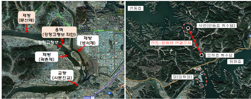
<그림 4-15> 수변구조물 안전통합관리시스템 계측기 설치 위치 (신동훈, 2016)
