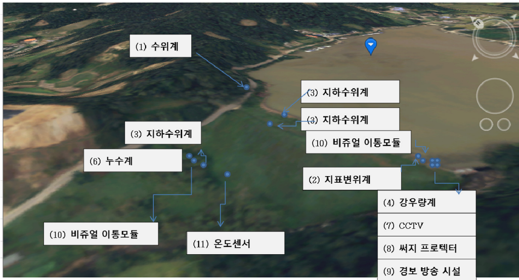
<그림 4-4> 어은 저수지 계측기 설치 위치(한국정보화진흥원 2014b)
