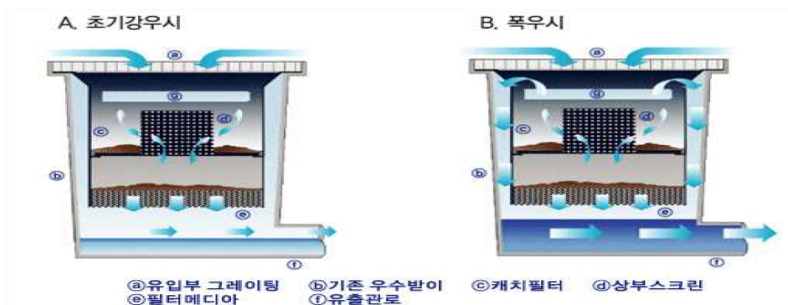
<그림 6-3> 필터형 초기우수처리 시설 개요도(Catch filter)
