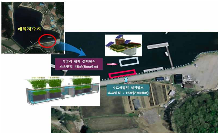
<그림 3-1> 접촉산화수로 및 접촉산화부도 설치 위치
