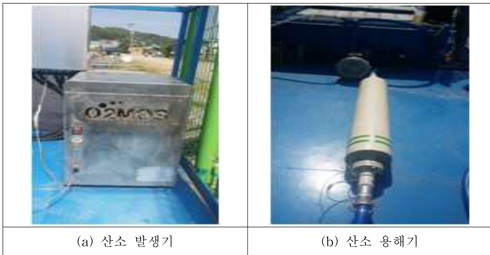
<그림 3-10> 산소 공급장치(산소발생기 및 산소용해기)
