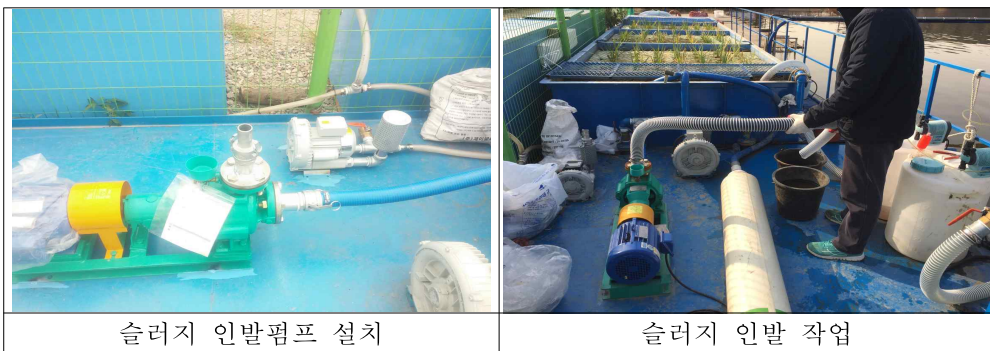
<그림 3-25> 생태융합형 접촉산화시스템의 슬러지 인발 실험
