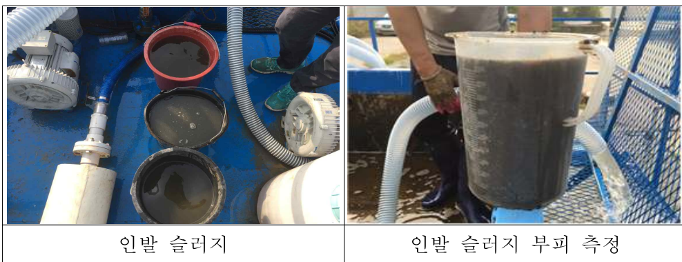
<그림 3-26> 생태융합형 접촉산화시스템의 인발된 슬러지
