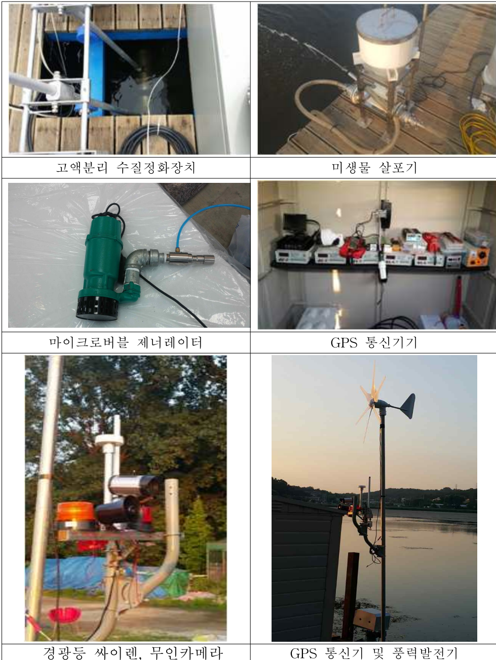
<그림 5-4> 무인항법 이동식 수질정화선 구성 장치
