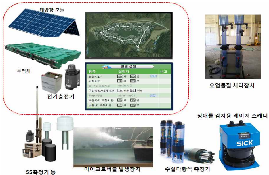
<그림 5-2> 무인항법 이동식 수질정화선 구성요소
