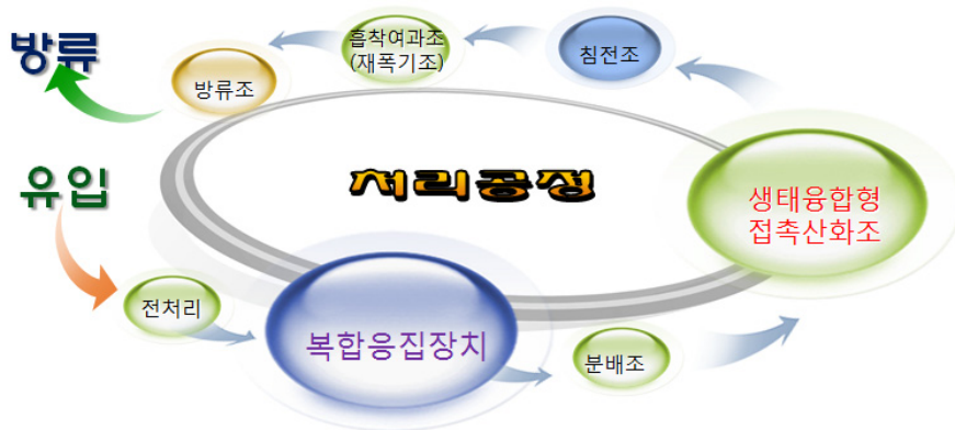
<그림 2.2-1> 농업용저수지 유입부 수처리시스템 공정
