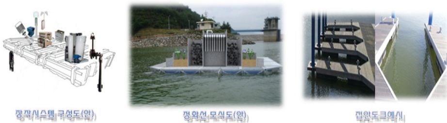
<그림 2.2-15> 무인항법 이동식 수질정화선 개념도
