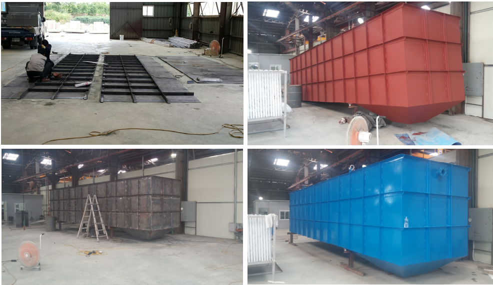
<그림 4.1-8> 접촉산화수로 몸체(BODY) 제작 공정
