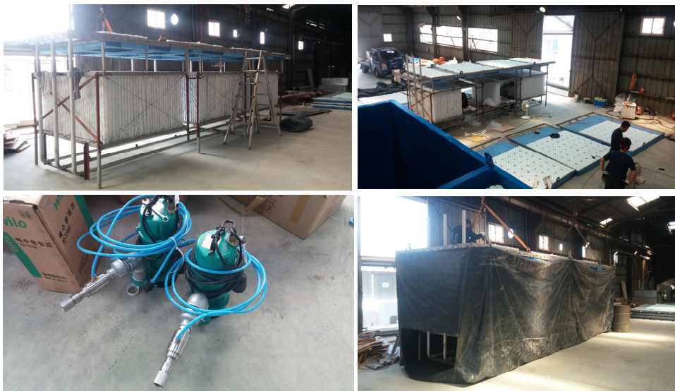
<그림 4.1-19> 접촉산화부도 배관류 제작 공정
