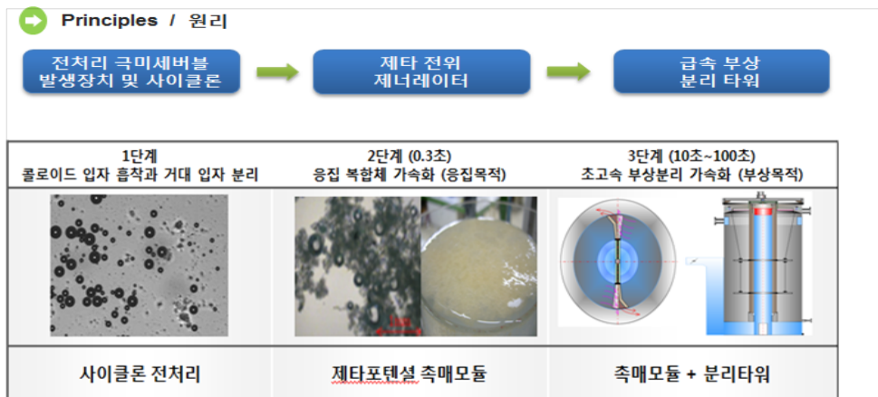
<그림 2.2-19> 초고속 부유물 고액분리시스템 기술 원리
