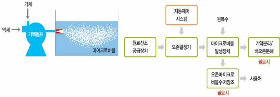
<그림 4.3-20> 오존마이크로버블 장치의 설비 구성
