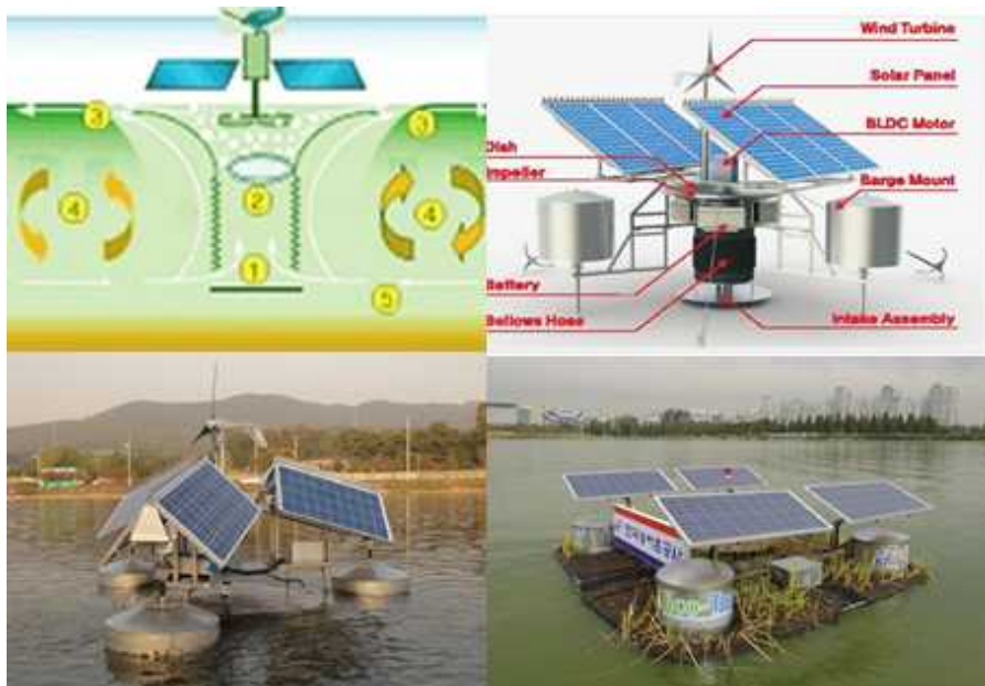
<그림 4.3-2> 인공물순환 원리 및 장치
