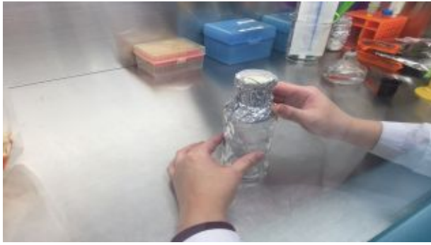
그림41 . 300ml 포장용 병 용기를 autoclave를 이용하여 멸균함(121℃에서 20분)
