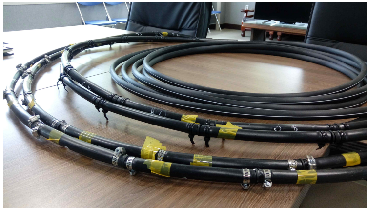
그림 ----. PC 드리퍼의 구성 조합을 달리한 드리퍼 호스(중복)
