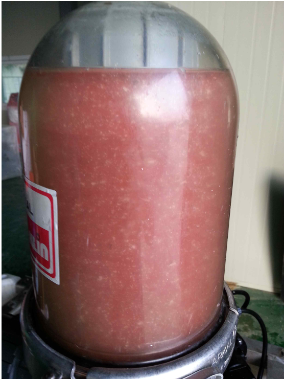
(c) 여과기 231초 후 상태
