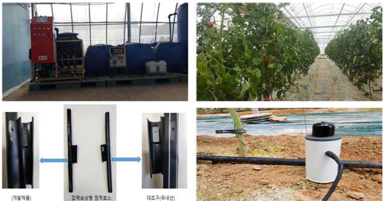
Fig 5. 압력보상형 관수시스템 및 시험포장 전경
