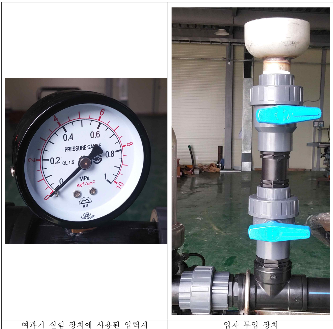
그림 3 여과기 실험에 사용된 압력계 및 입자 투입 장치
