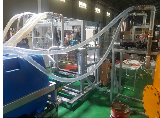
그림 29 자동역세 여과기 성능평가 실험 장치
