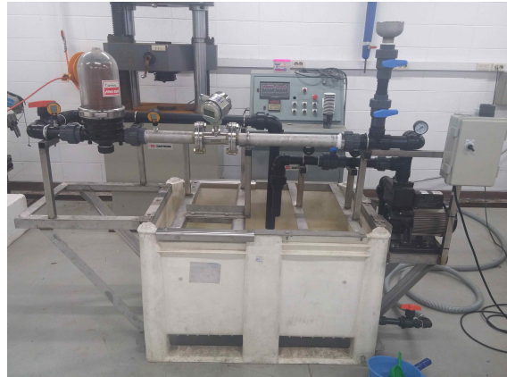
그림 26 일반형 여과기 성능평가 실험 장치
