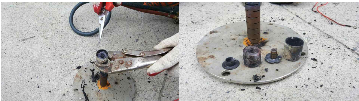
(버마드 솔레노이드 분석을 위한 분해 전경 - 부속품 구조 및 형태 파악)
