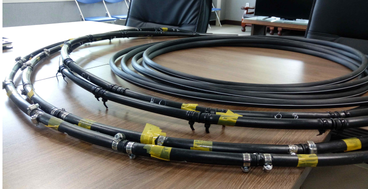
그림 ----. 조건이 다른 PC dripper가 조립된 실험용 호스
