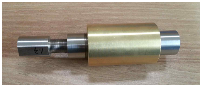
그림 --- 스프링클러의 실험용 지그 조립상태
