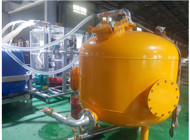
그림 30 모래여과기 성능 평가 실험 장치 모식도
