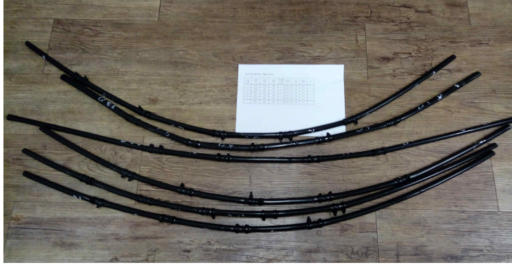
그림 ---. 실리콘 경도를 달리한 드리퍼 실험용 호스
