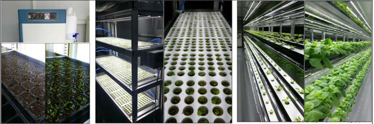
그림 1. 밀폐형 식물생산시스템 [발아실(좌), 담액형 육묘대(중), 박막형 재배대(우)]
