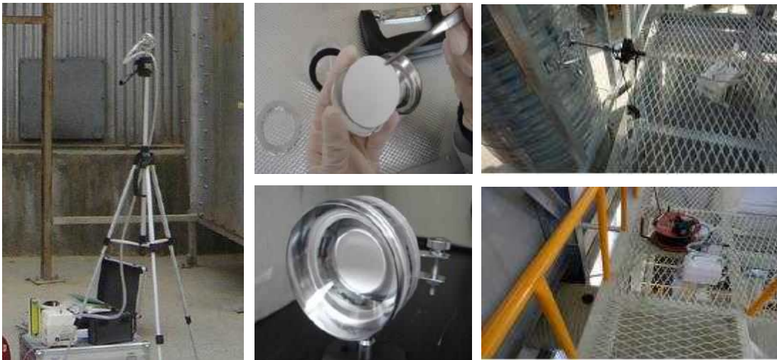
그림 2-2-1-8. 분진농도 측정에 사용된 Low volume sampler 및 측정모습
