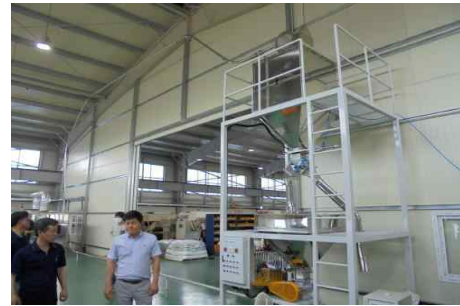
그림 2-2-2-22. 공기이송시스템 시작품의 전경 및 투입부
