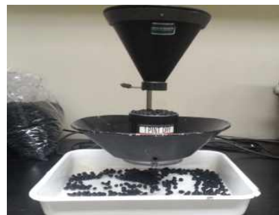
그림 2-3-3. 산물밀도 측정장치의 주요 제원(mm) 및 Seedburo사의 산물밀도 측정장치
