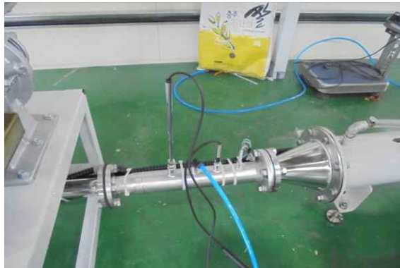
그림 2-2-2-19. 공기이송시스템 시작품에 온습도, 풍속, 정압 측정센서가 설치된 모습
