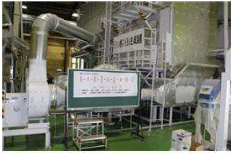
그림 2-1-2-7. 佐竹鐵工株式會社에 설치된 GABA제조시스템(3ton/batch, 백미기준)과 전처리시스템
