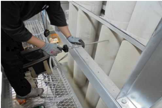
(여과포(집진시스템 토출부) 분진농도 측정)
