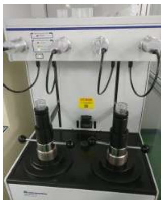
그림 2-2-1-29. 여과포의 기공측정을 위해 사용된 AutoPore IV 9500
