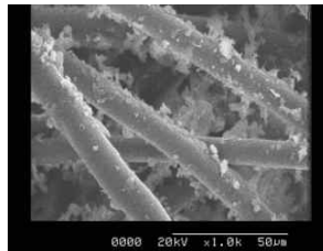
여과포11 (여과포 통과속도 0.5m/min, 분진농도 10mg/m 3 )
