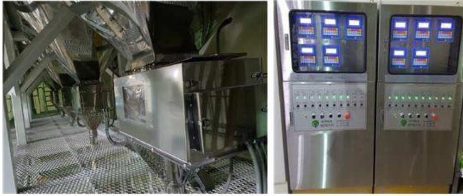
그림 2-1-5-8. 2 nd G RPC인 충북 청주소재 민간RPC에 설치된 grid scale로 구성된 혼합미 제조시스템
