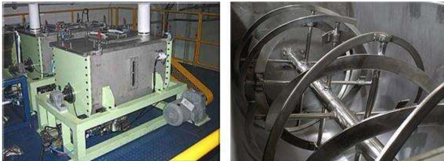
그림 2-1-5-7. 혼합미제조시스템에서 사용중인 리본믹스 형태의 혼합기
