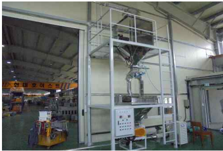
그림 2-2-2-22. 공기이송시스템 시작품의 전경 및 투입부
