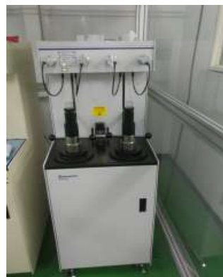
그림 2-2-1-29. 여과포의 기공측정을 위해 사용된 AutoPore IV 9500
