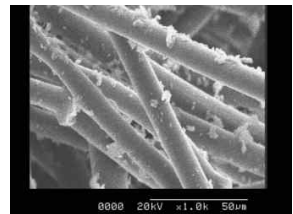
여과포14 (여과포 통과속도 5.0m/min, 분진농도 10mg/m 3 )
