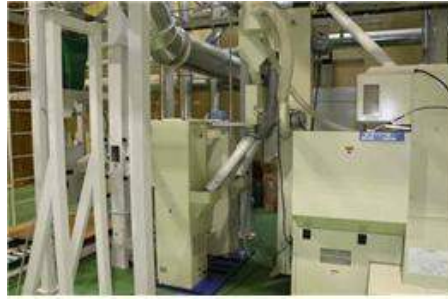
그림 2-1-2-7. 佐竹鐵工株式會社에 설치된 GABA제조시스템(3ton/batch, 백미기준)과 전처리시스템
