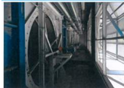
그림 2-2-1-6. 일본 CE에서 사용되고 있는 대용량 집진시스템(로터리집진기)
