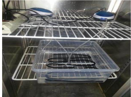
(산소공급기, 분배기 설치)
