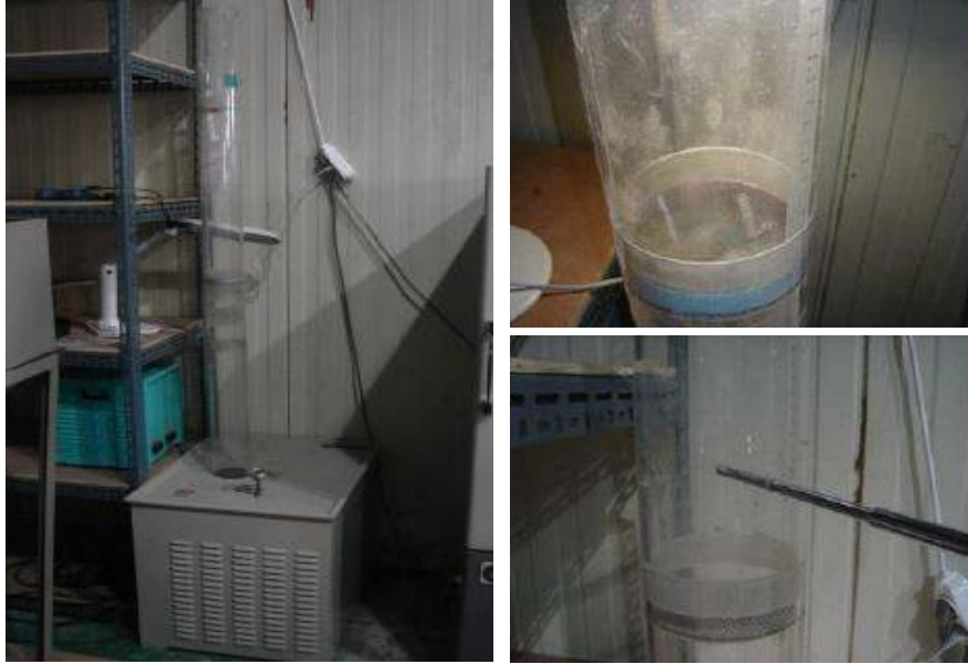
그림 2-1-1-37. 배아, 잔싸라기 및 미강의 종말속도 측정을 위해 사용된 풍동
