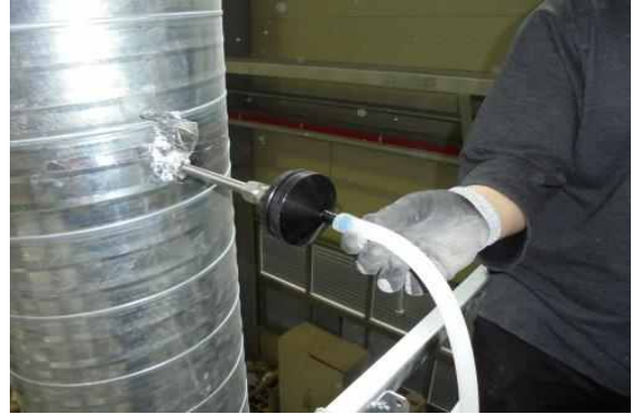
(집진시스템 유입부 분진농도 측정)
