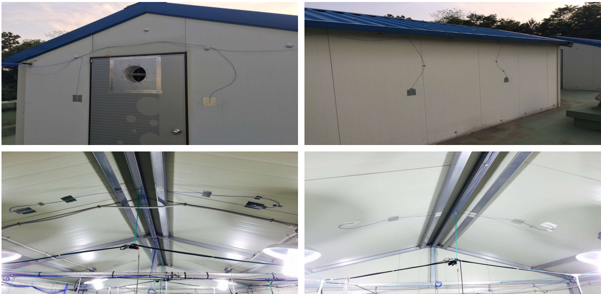
[그림] 실험돈사 내·외부 벽체 온도 측정
