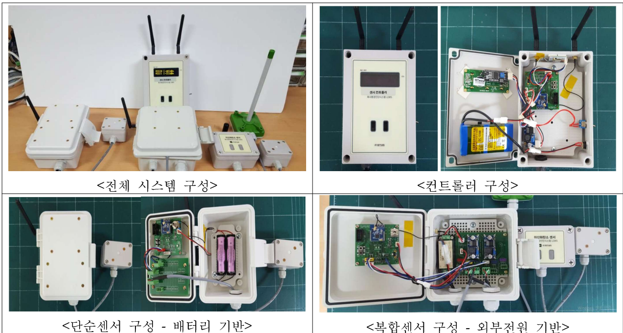
[그림] ZigBee 기반 무선통신 모듈 구성
