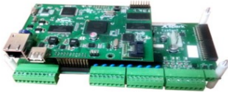
[그림] 1차년도 소비 전력 측정용 Main Processing Unit
