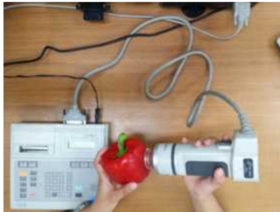
그림 59 크로마미터를 이용한 색도 측정
