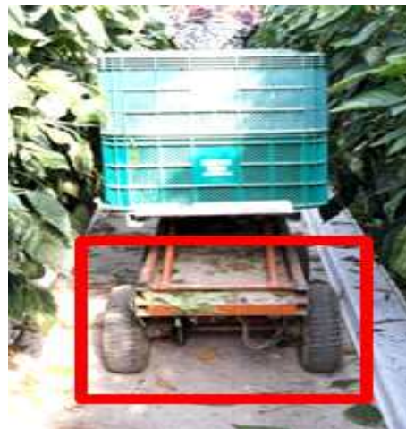
그림 40 흠으로 된 노면과 방향 전환이 용이 하지 않은 바퀴
