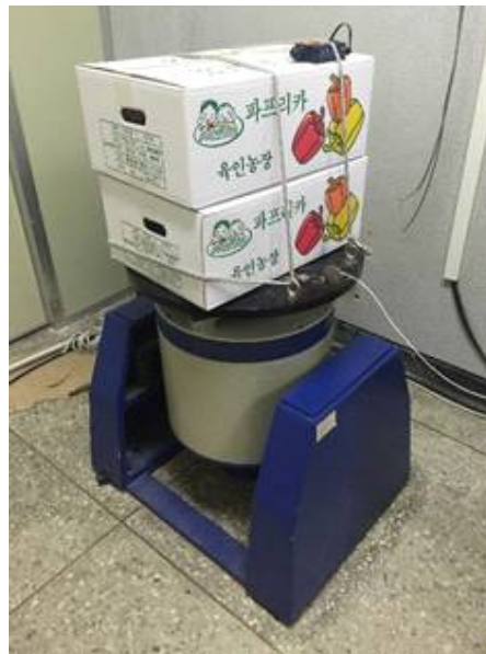
그림 55 충격시험에 사용된 가진기와 과프리카 상자
