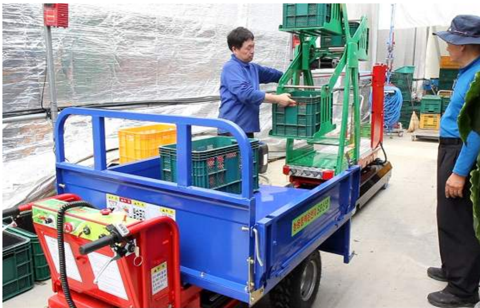
그림 132 수확용 작업차에서 동력운반차로 과일상자를 운반하는 모습
