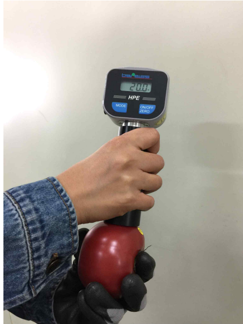
그림 71 비파괴 경도계를 이용한 샘플의 경도측정
