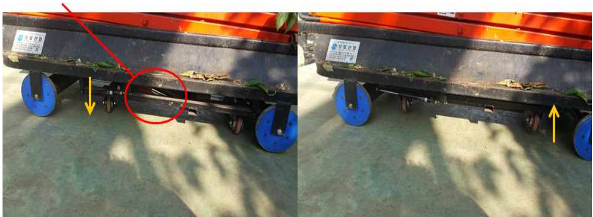
그림 42 라인 이동시 보조바퀴가 나옴, 작업자가 밀어야하는 불편한 상태
