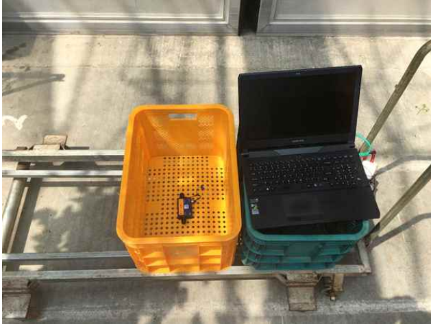
그림 33 . 충격을 측정하기 위한 센서 시스템
