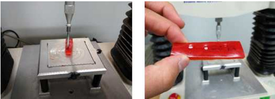
그림 58 UTM을 이용한 샘플의 경도 측정
