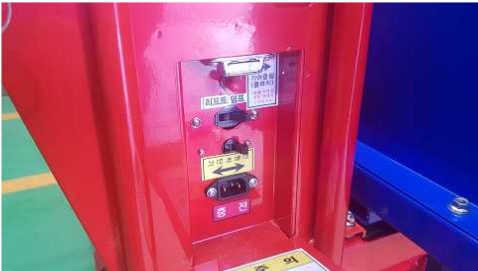
그림 128 리프트 기능과 덤프 기능을 조절할 수 있는 레버
