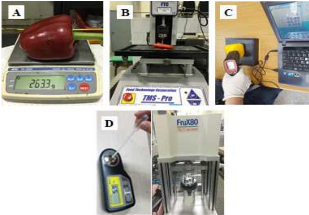
그림 88. 품질 매개 변수의 측정 : A. 무게측정; B. 견고성 측정; C. 색상 매개변수 측정; D. TSS측정
