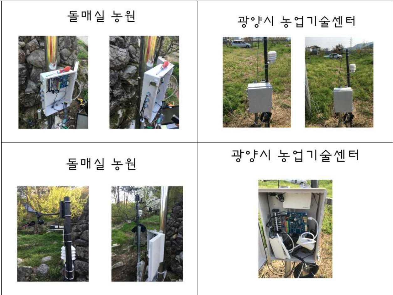
그림133. 환경센서 수집기 현장 설치
