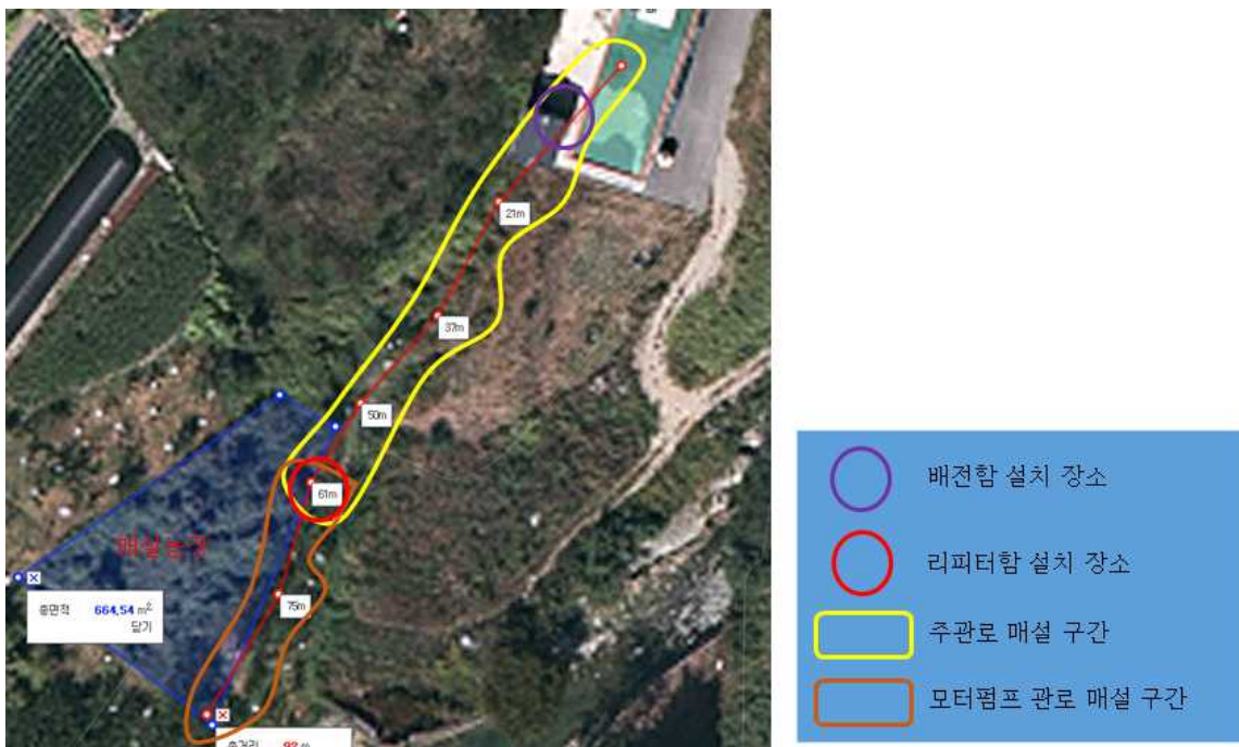
그림157. 서리예방을 위한 미세살수 시스템 설치도
