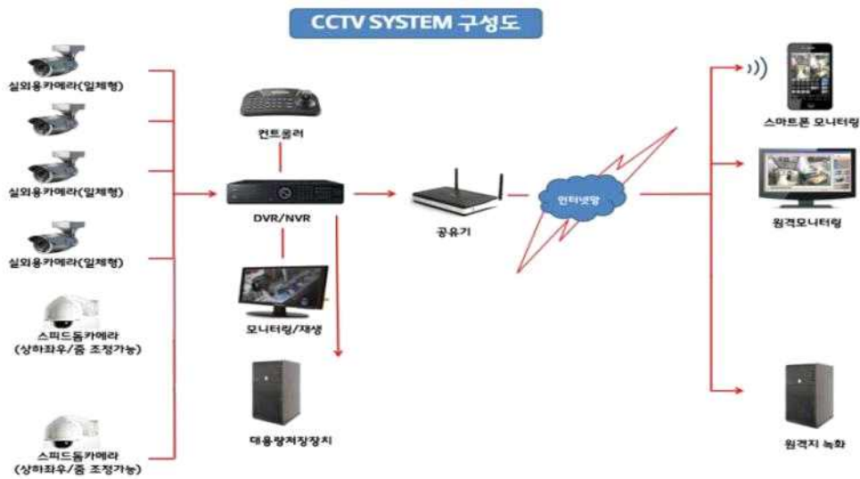
그림122. 매실재배지 CCTV 시스템 구성도
