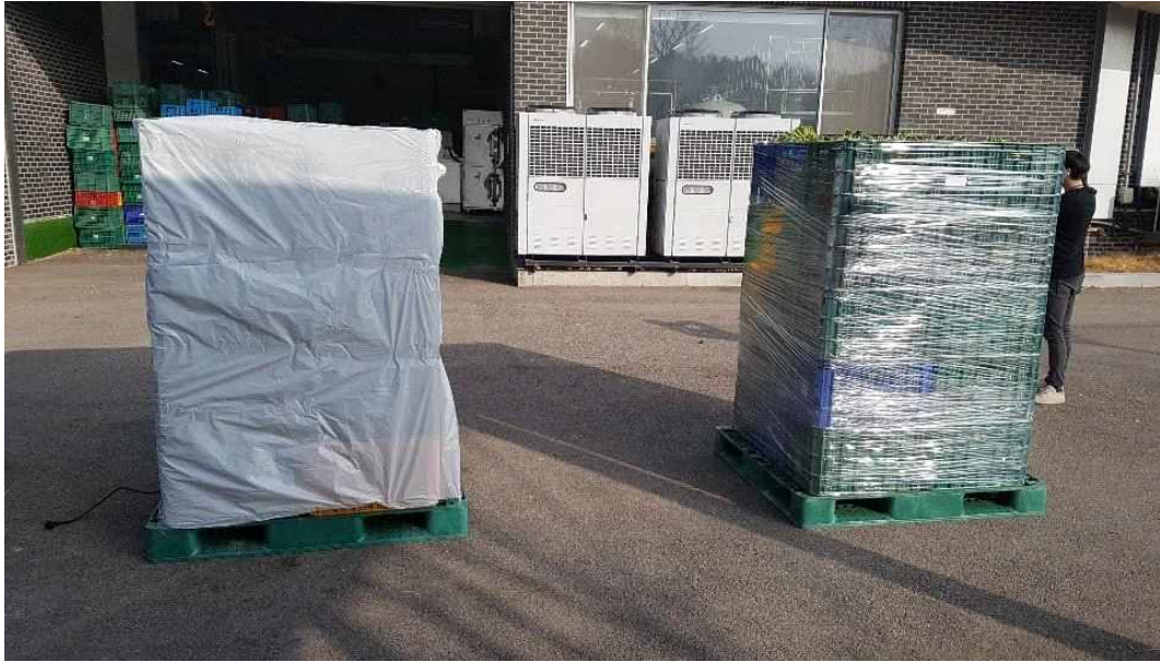
그림 4-7. 겨울배추의 팔릿단위 스트레치 필름 및 커버 포장
