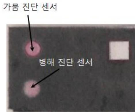
그림76. 제작된 가뭄 및 병해를 동시에 진단할 수 있는 종이 기반 센서를 사용한 가뭄 및 병해를 진단한 이미지
