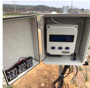
그림66. 환경 계측 모니터링 시스템 내부 모습
