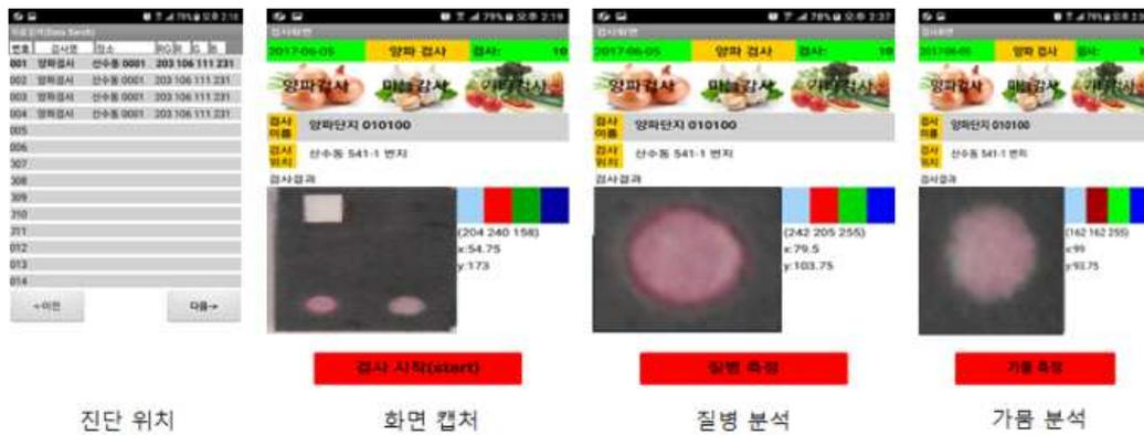
그림91. 제작된 app을 사용하여 가뭄 및 병해진단을 위하여 종이센서의 색상의 정도를 분석하는 과정
