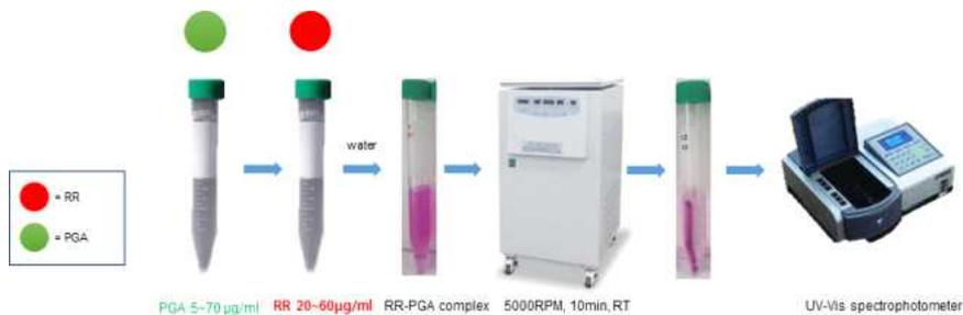
그림59. PGA-RR의 최적 결합 비율 확인을 위한 실험 개략도
