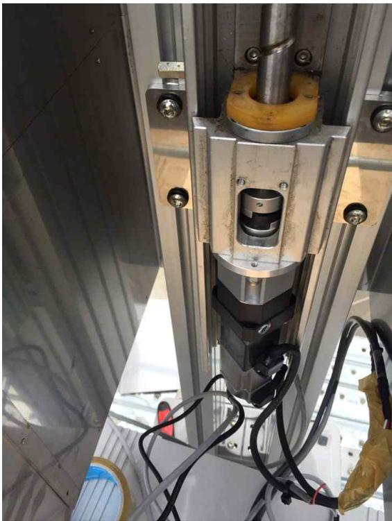
그림246. 스테핑 모터 장착 모습
