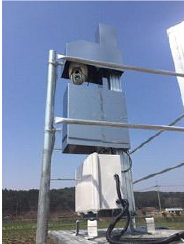
그림251. 실시간 영상획득 모니터링 시스템
