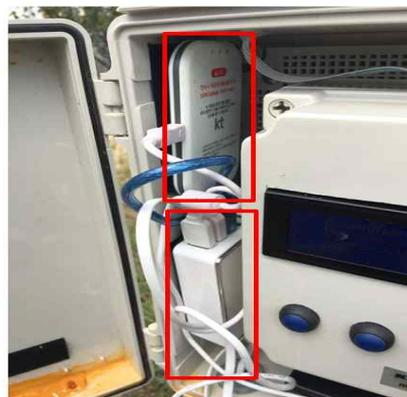
그림278. 에그 및 배터리 설치
