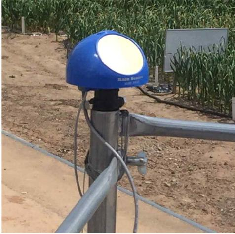
그림249. 눈과 비가 올 경우 카메라 작동 중지를 위한 우적센서
