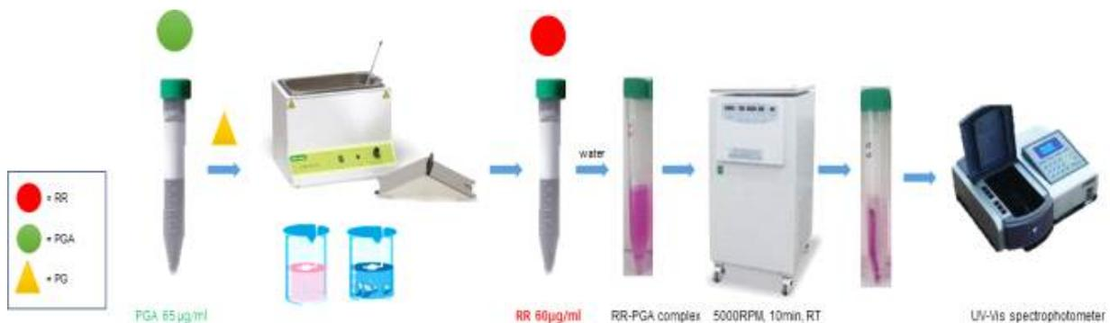
그림60. PG 활성도 측정을 위한 실험 개략도
