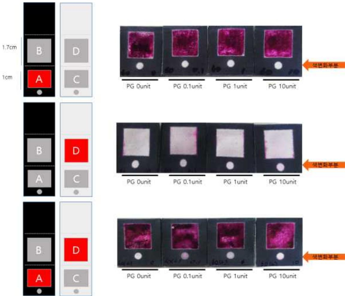
그림67. PG 활성 측정 종이 센서 개발 위한 PGA-RR complex 면 다양화
