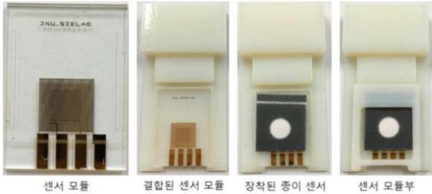
그림 27. 센서모듈 케이스 및 모듈이 조립된 센서모듈의 광학 이미지
