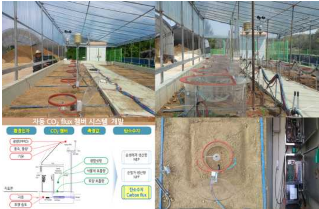
그림 117. 자동 CO 2 Flux Chamber System 개발제작 및 야외 설치 운영
