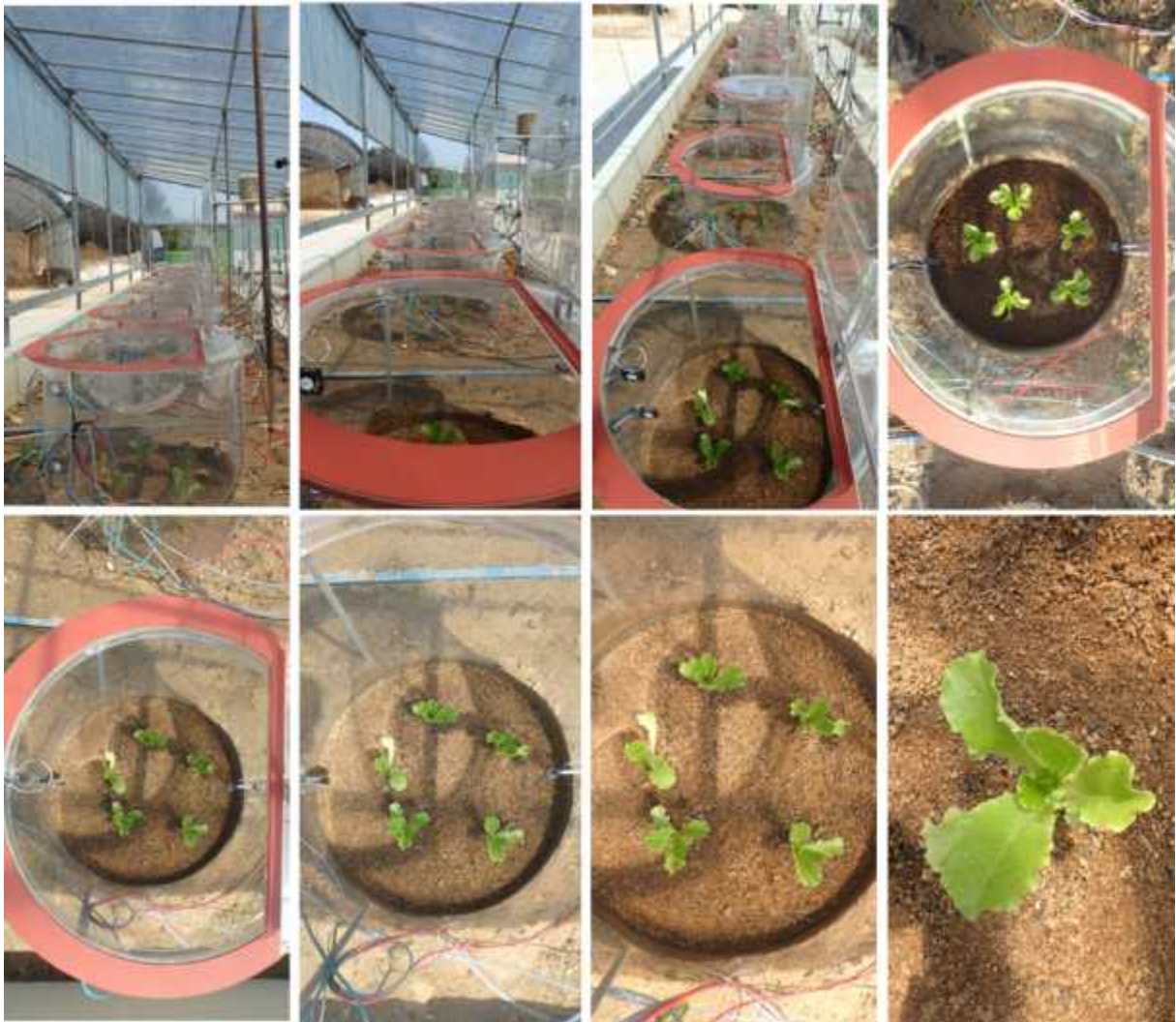
그림 118. 2018년도 봄에 사용한 CO 2 flux chamber system에서 상추재배토양(CS구와 CSB구)의 경우, 8개의 대형 chamber(직경 70cm, 높이 61cm) 내부 안쪽에 5주의 청상추를 정식하여 재배함.
