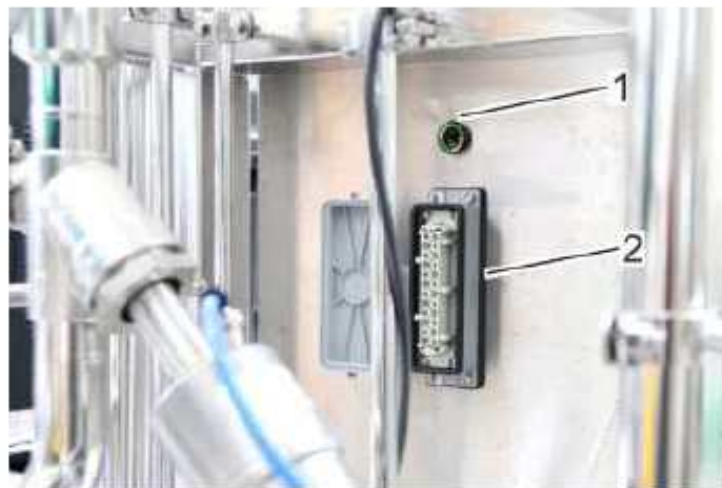
<Fig.23 배양기의 Mobile CIP 시그널 커넥터 연결>
