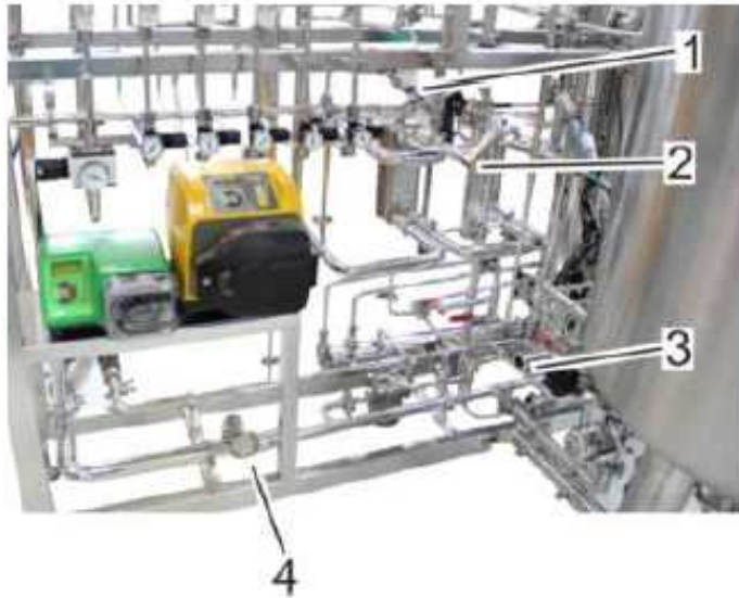
<Fig.22 배양기의 Mobile CIP 배관 연결부위>
