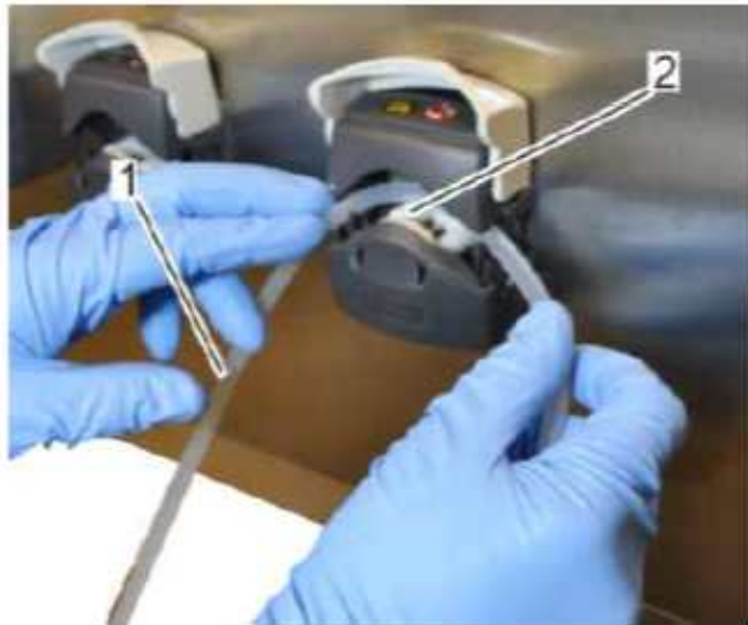
<Fig.17 Base pump에 튜빙 연결>
