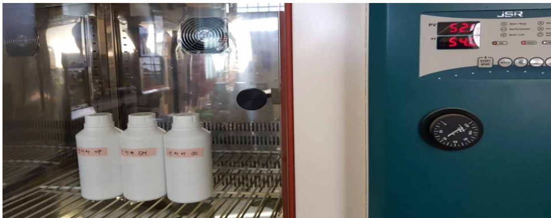
그림 13. 시제품의 가열안정성 시험.
