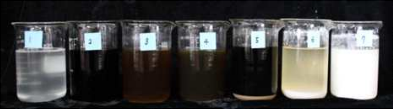
그림 8 . 계면활성제 종류 별 수화성 및 현탁성 1차 시험.
