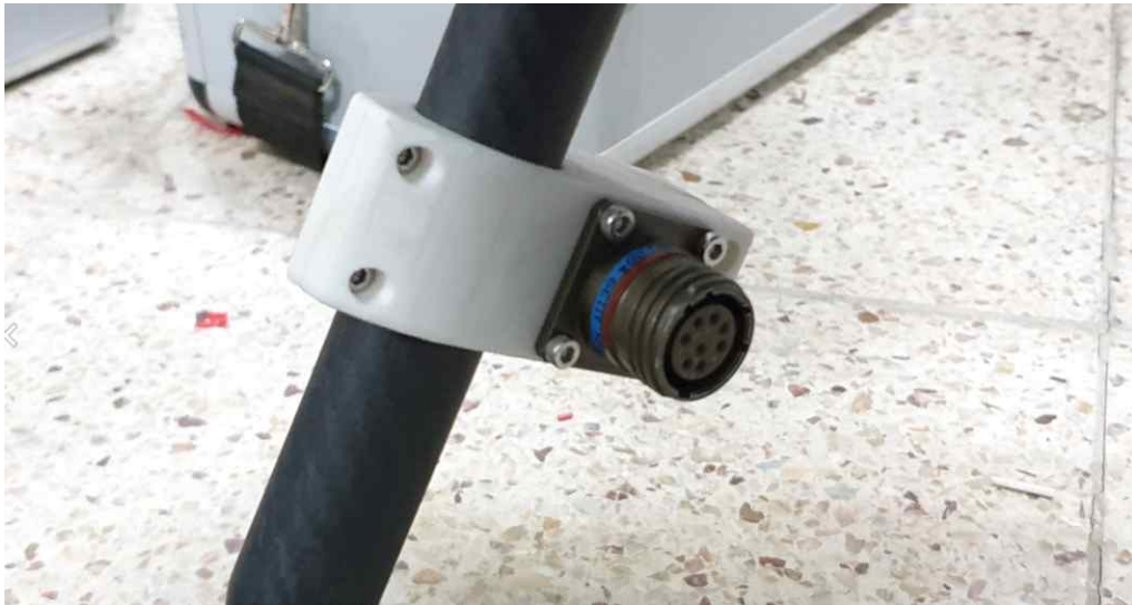
그림 13. 입제살포장치 및 펌프장치 연결 커넥터(개선)
