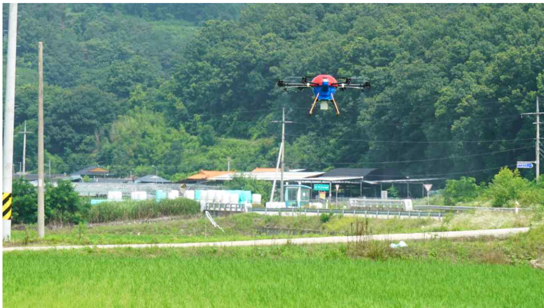
그림 71. 항공방제용 무인기 농약살포 비행시험(경북대 실증지역)
