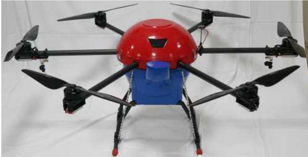
그림 87. 제작 완료된 항공방제용 무인기 시제품
