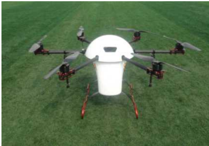
그림 80. 제작된 항공방제용 무인기(1, 2호기)
