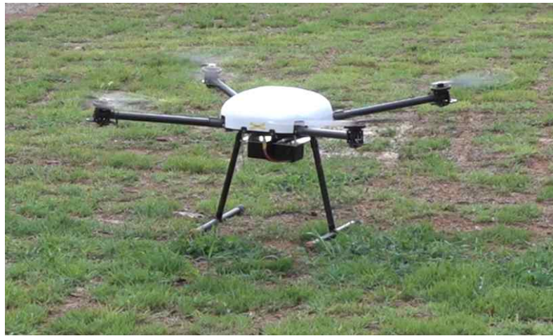
그림 17. 병충해 모니터링용 무인기 제작 기체
