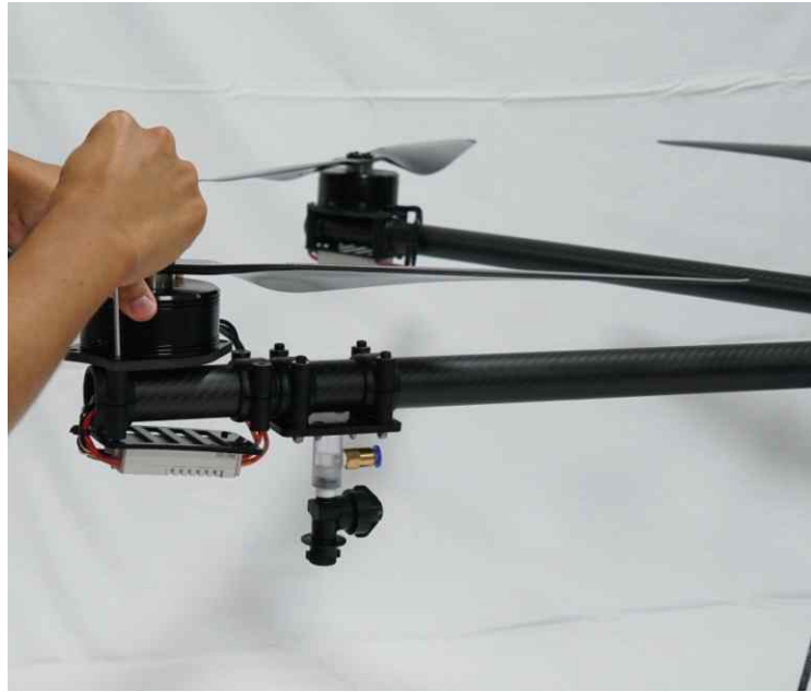
그림 85. 변속기와 모터 장착
