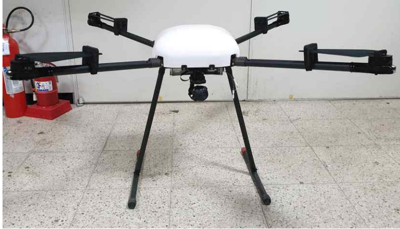
그림 92. 제작 완료된 병충해 모니터링용 소형 무인기 시제품
