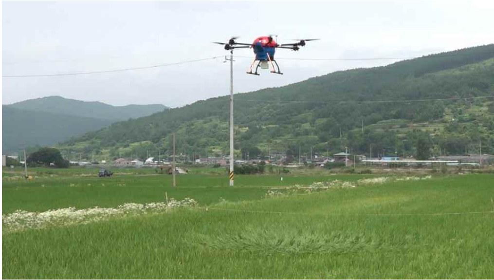
그림 72. 항공방제용 무인기 농약살포 비행시험(경북대 실증지역)
