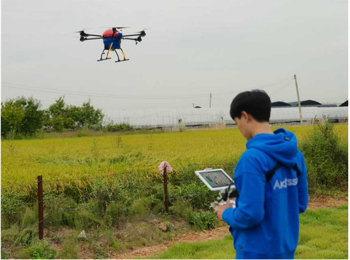
그림 130. 지상통제시스템과 방제맵 서버와의 연동시험
