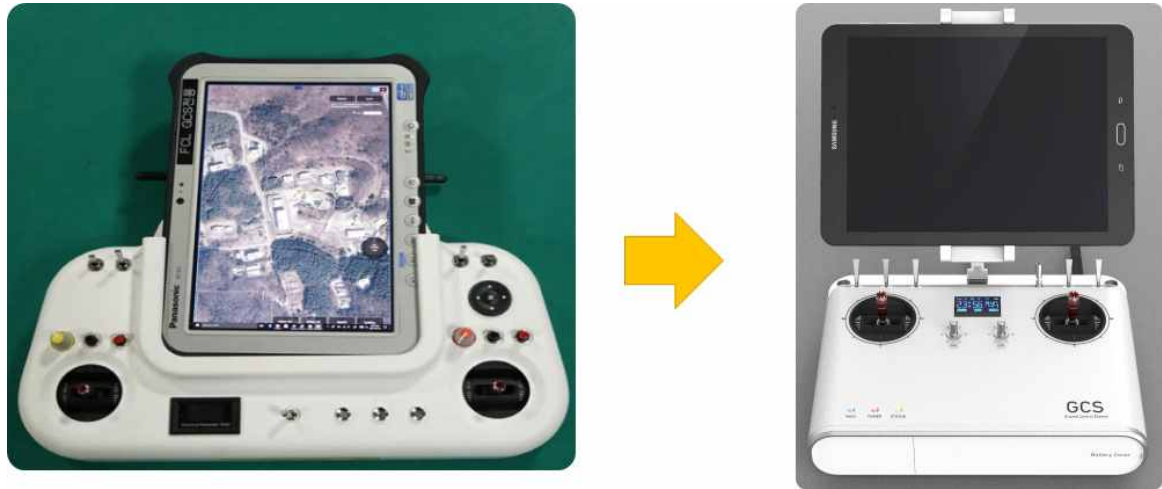
그림 38. 2차년도 조종장치 시제품(좌) 최종 시제품(우)
