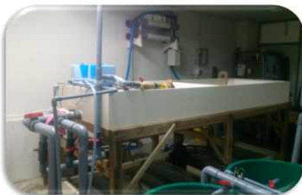
장기간 떡장어 사육 및 유지를 위한 실험실 내 해수정화 및 자외선 살균 시스템
