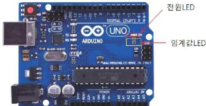
사진 5-4. 자기기록 텐시오미터의 마이크로컨트롤러 보드(Arduino Uno)에는 붉은 색의 전원 LED와 녹색의 임계값 표시 LED가 있다.
