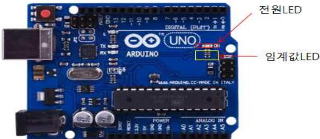
그림 5. Arduino Uno의 전원LED와 토양 수분 포텐셜 임계값에 도달했을 때 점멸하는 LED
