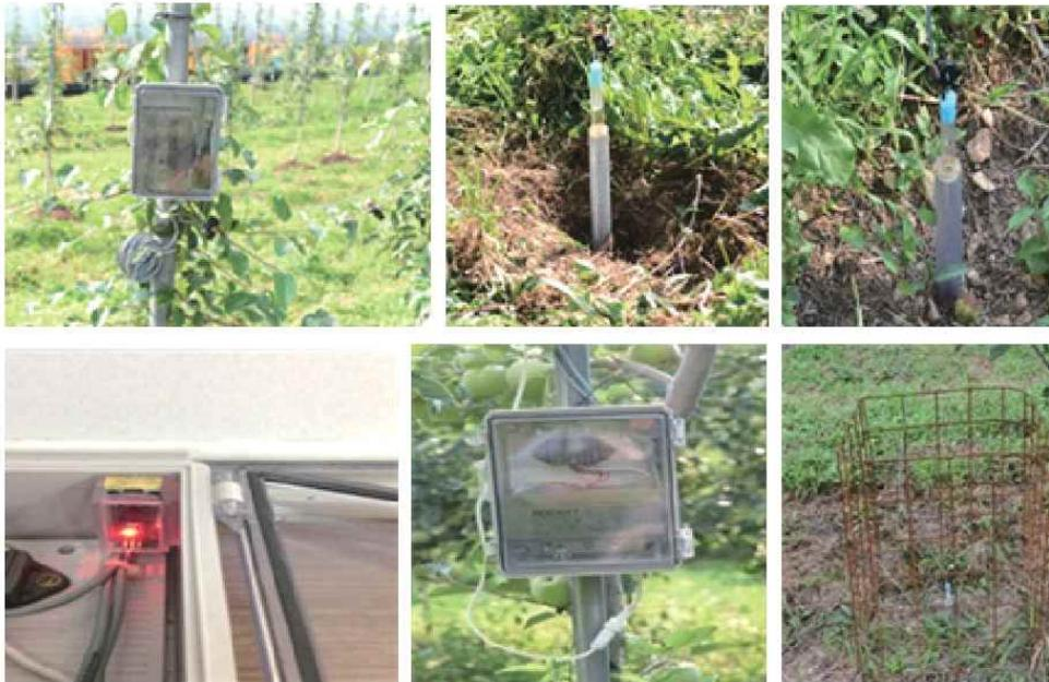
사진 5-3. 자기기록 텐시오미터의 설치사례. 지주에 컨트롤박스를 고정하고 대표적인 나무를 골라 원줄기와 30cm, 점적기와 20~30cm 지점에 쇠파이프로 유도 구멍을 낸 다음 텐시오미터 선단이 25~30cm 깊이로 위치하게 꽂고 표토로 틈새를 채워 빈틈이 없게 하고 투명관에 깨끗한 물을 채우고 압력계가 부착된 실리콘 마개를 끼워 막는다. 컨트롤박스의 LED가 켜지면 작동이 되는 것이므로 컨트롤 박스를 채우고 텐시오미터가 작업 시 손상되는 것을 막기 위해 보호망을 세운다.
