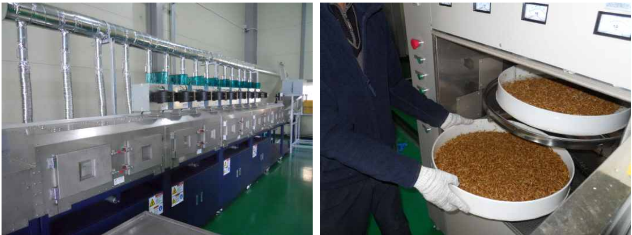
그림. 컨베이어벨트형 건조기와 본과제로 개발된 건조기(2단)
