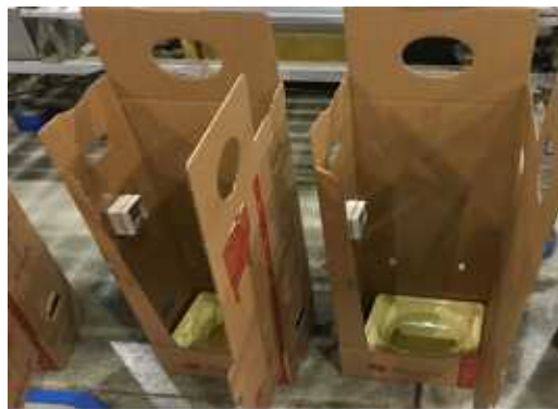
그림 1-59. 환경센서(Hobo-H8pro)를 수출박스에 부착한 모습
