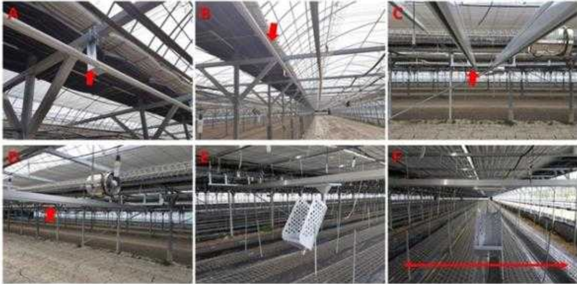
그림 3-12. 절화 국화의 천정형 습식용 수확용기의 설치 모습(A : 레일 고정 브라켓, B : 천정형 레일, C-D : 수확용 습식용기 이동 레일, E : 수확용 습식용기, F : 수확용 습식용기 이동 방향)
