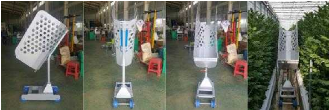
그림 3-9. 절화 국화의 지상형 습식용 수확용기와 레일 설치 도면 및 제작된 시제품
