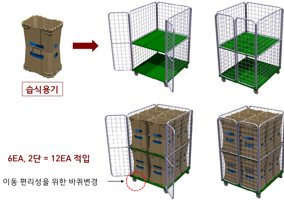
그림 1-5. 수확용 습식밀차 모식도(1200 X 1000 X 180mm)
