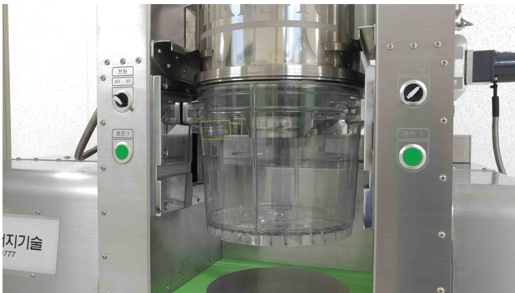
그림 17 대두분 집진용 집진시스템
