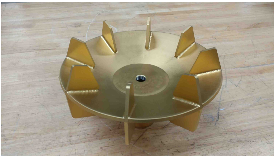
그림-5 Radial type rotor for pulverizer Mill.
