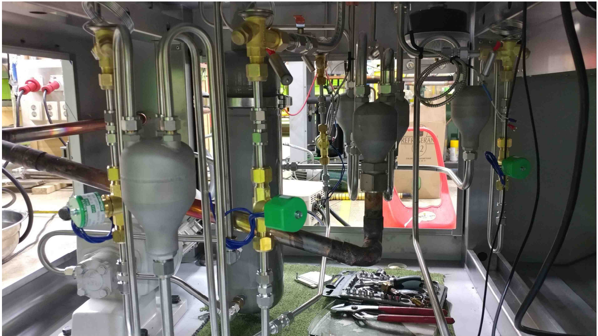
그림 16 실제 제작된 분쇄기의 냉각라인
