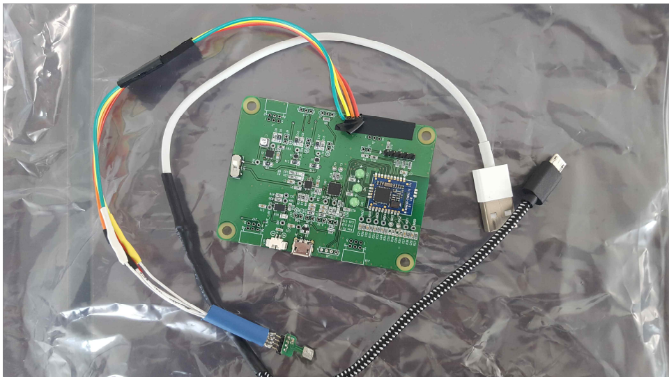
- 센서 PCB 부품마운트 後 -
