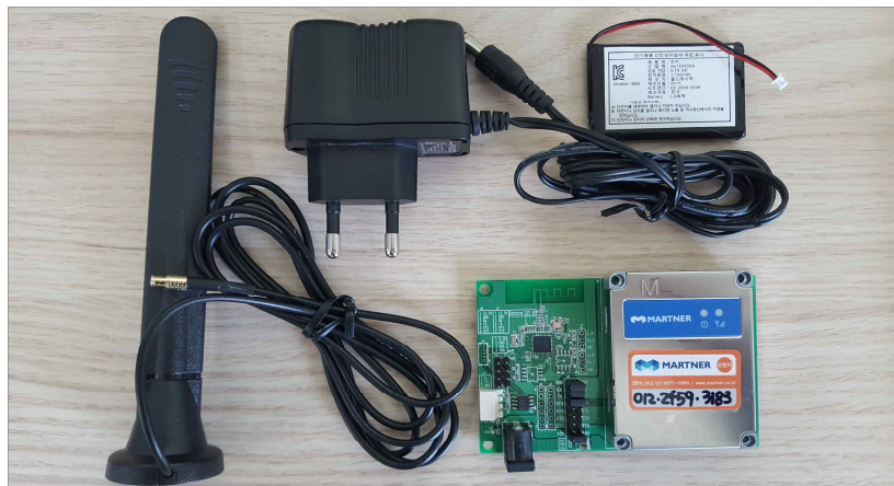
- 중계장치 구성 (통신모뎀, 안테나, 상시전원, 배터리) -
