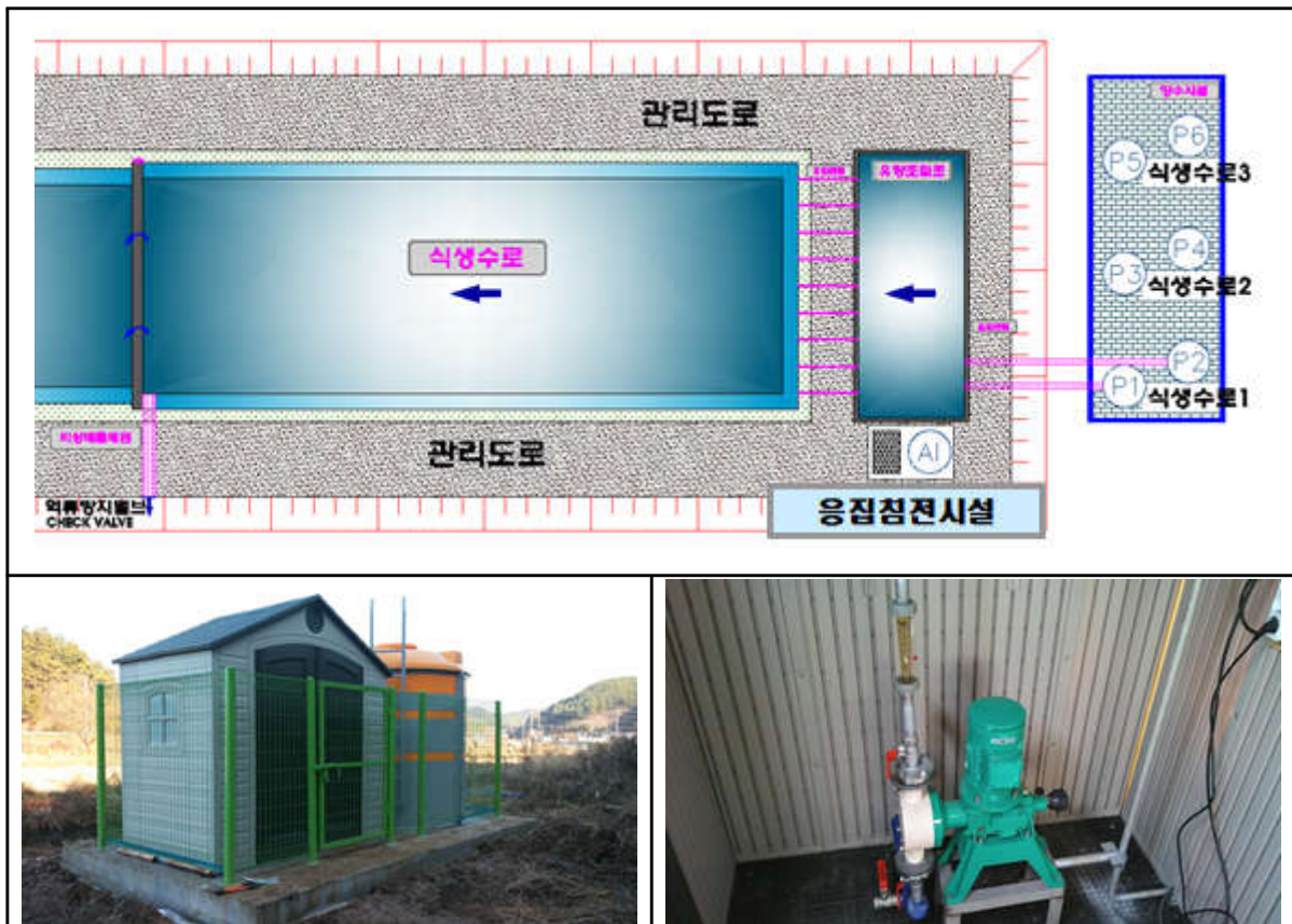
(그림 5.6-5) 응집침전장치 위치도 및 구성 예시(지상형)
