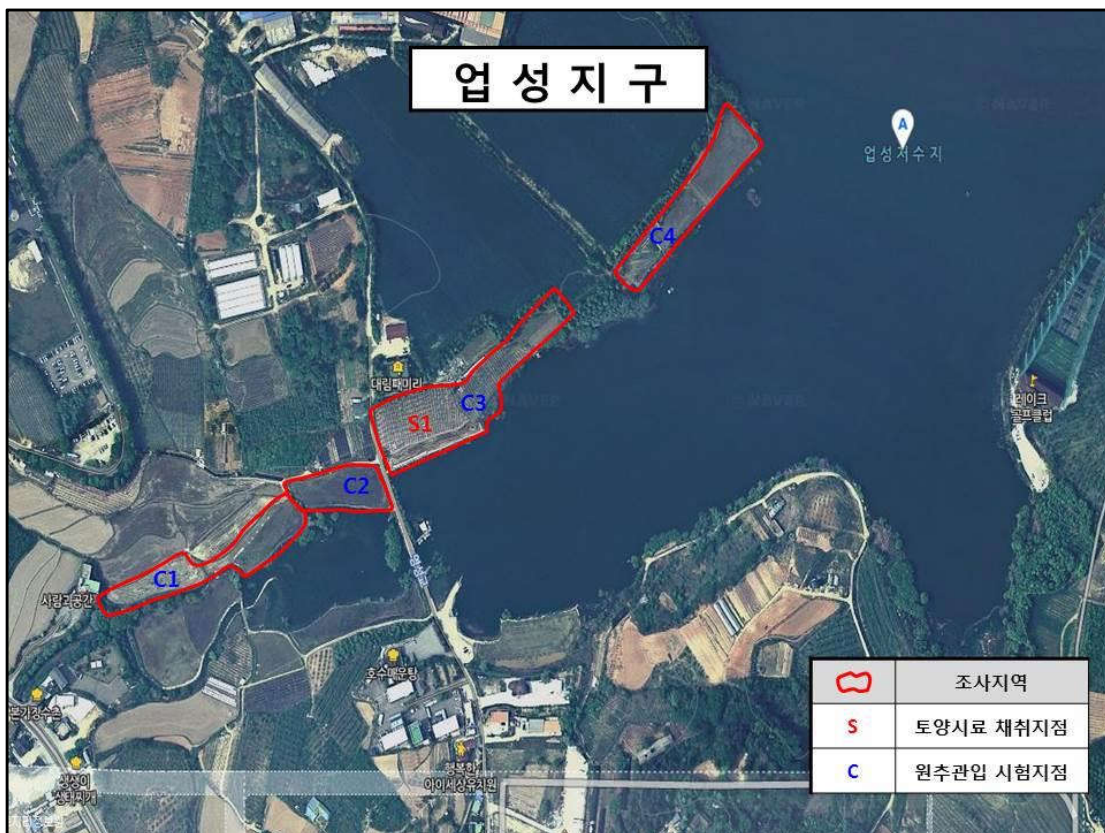
(그림 3.4-1) 조사지역 및 시료채취·원추관입 시험지점
