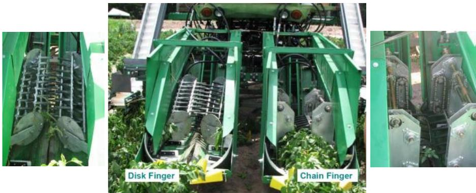
그림 6. Disk finger(좌) and Chain finger(우) type
