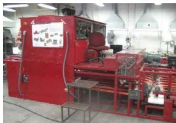
그림 31. 영상이미지 및 NIR 센서를 이용한 고추 꼭지제거장치 시제품(M-TEC, 2012. 10)
