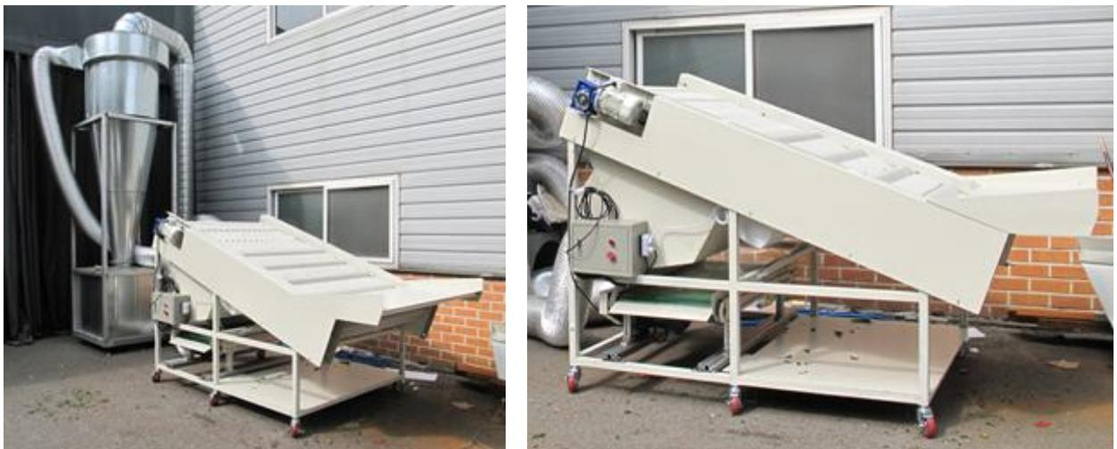
그림 118. Cleaning card를 이용한 생고추 원료 이물질 선별장치 2차 시작품 외형
