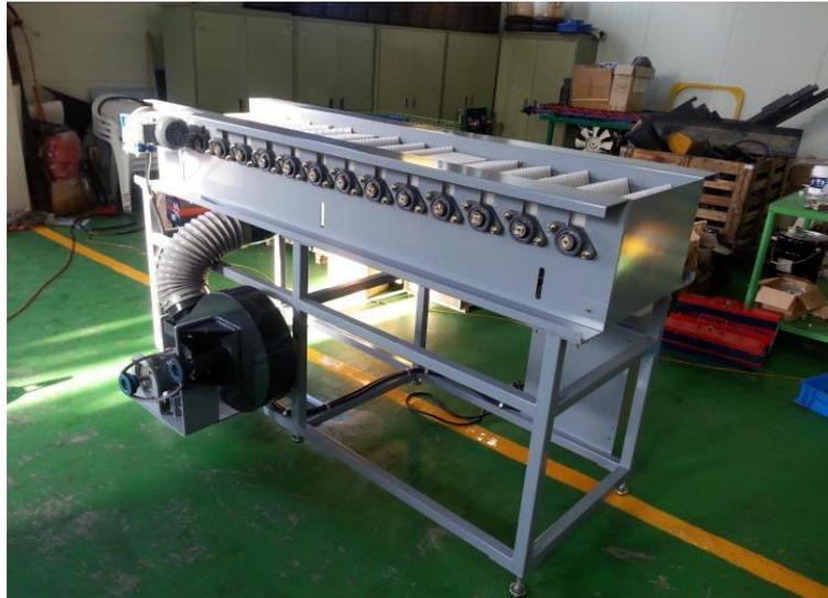
그림 15. 선별부 요인시험 장치(카드 클리너 + 풍구)
