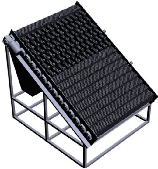
그림 84. cleaning card를 이용한 생고추 원료 이물질 선별장치 1차 시작품 개략도
