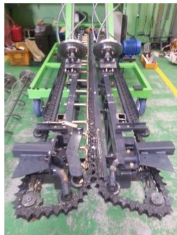
그림 1. 직경 230 mm의 helix를 장착한 탈실부 요인시험 장치
