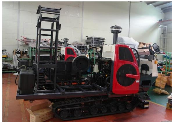
그림 37. Pilot 고추수확기 부품제작 및 조립
