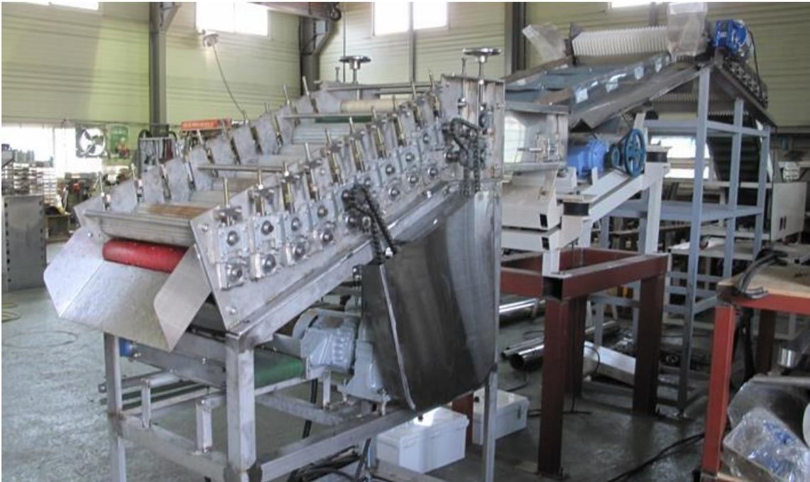
그림 97. 생고추 원료의 압축인장식 고추꼭지제거 장치 2차 시작품(2016. 4)
