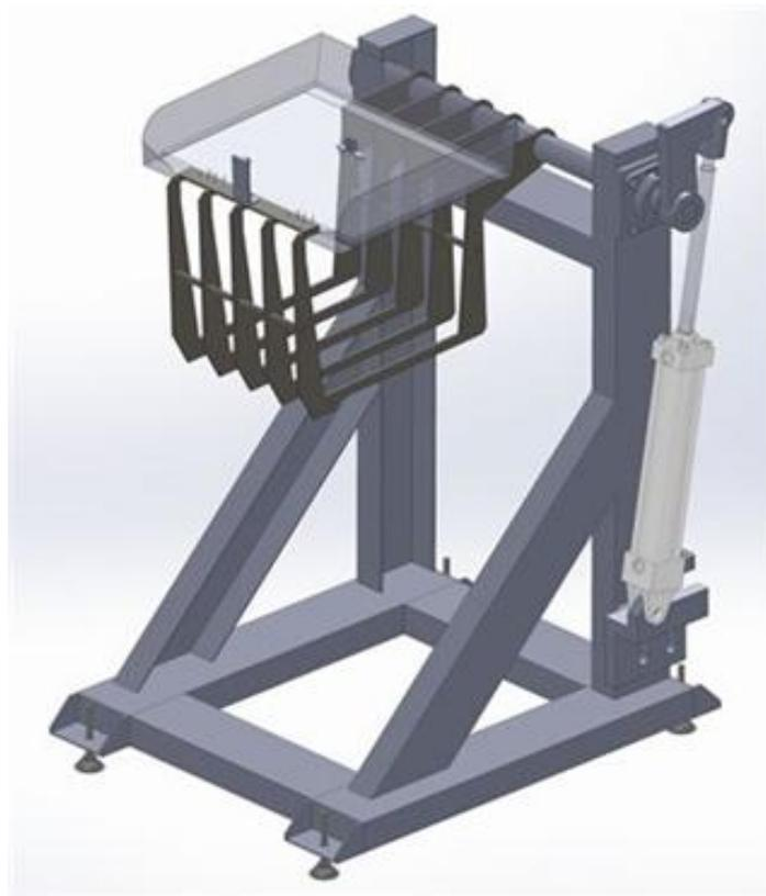
그림 125. 고추공급장치 덩핑 공급장치 설계(2차년도 설계)
