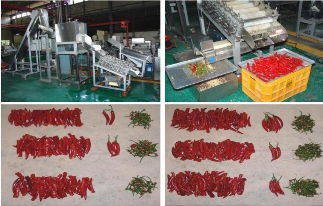
그림 24. 압축인장 롤조합 생고추 원료 꼭지제거 시스템 시작품(식품연/박재복, 2006. 10)
