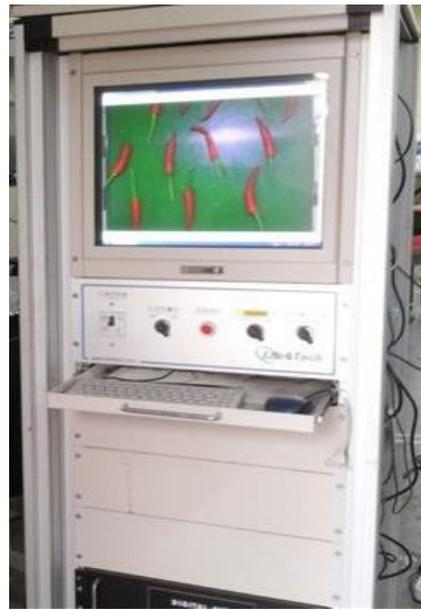
그림 100. 카메라 비전을 위한 컴퓨터 시스템
