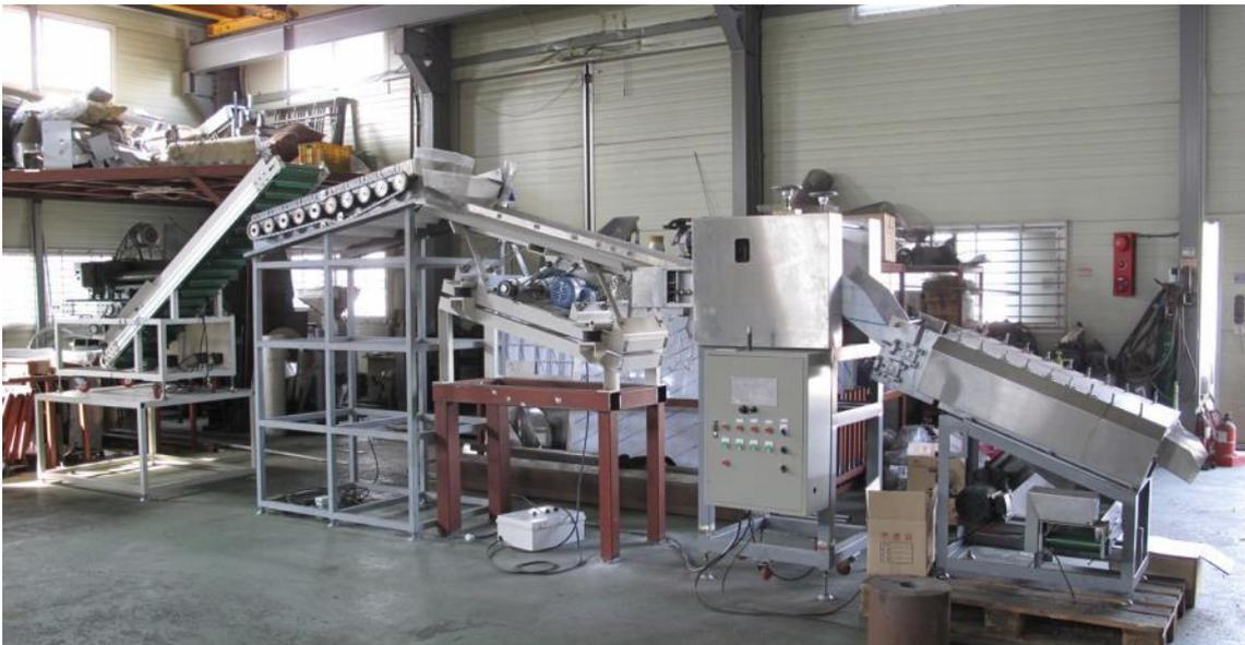
그림 73. 생고추 원료의 압축인장식 고추꼭지제거 장치 1차 시작품(2015. 5. 13)
