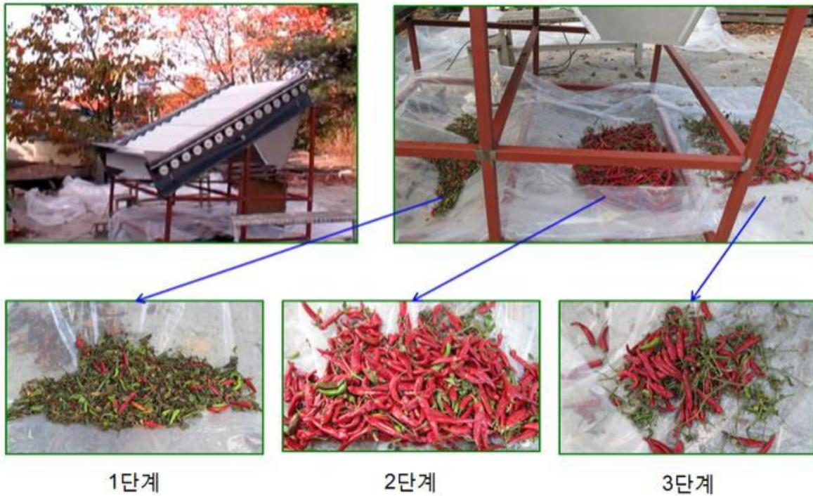
그림 87. Cleaning card를 이용한 생고추 원료 이물질 선별 실험
