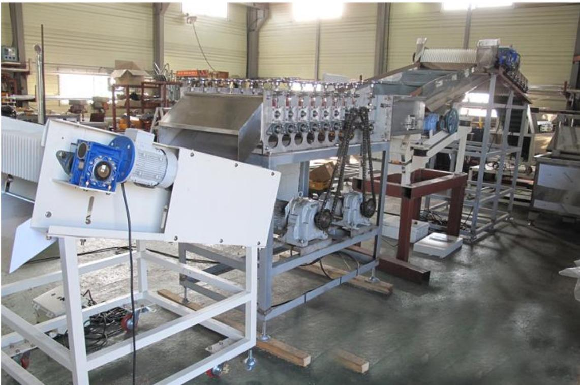
그림 137. 생고추 원료의 압축인장식 고추꼭지제거 장치 3차 시작품(2017. 9)
