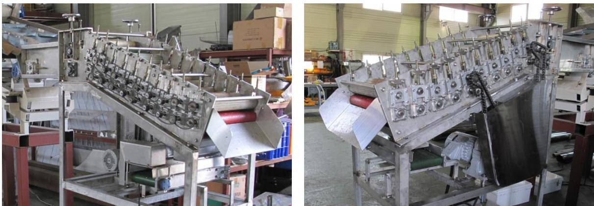
그림 121. 압축인장식 고추꼭지제거 장치 2차 시작품의 압축롤 및 실리콘롤 조합
