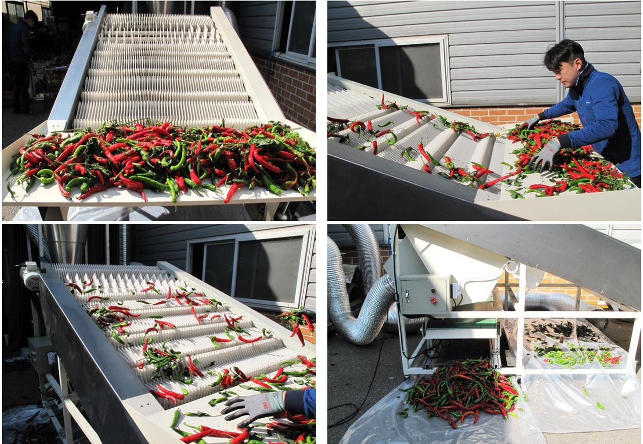
그림 121. 클리닝 카드를 이용한 생고추 원료 이물질 선별장치 시작품 성능 실험
