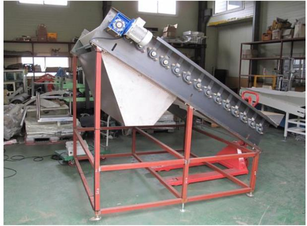
그림 83. Cleaning card를 이용한 생고추 원료 이물질 선별장치 1차 시작품 외형
