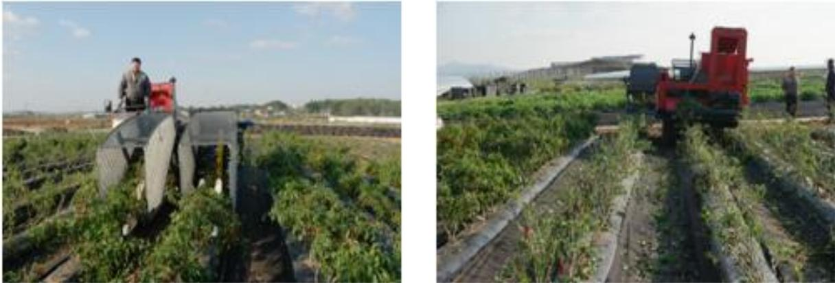
그림 18. 2조 고추수확기계 수확 시험
