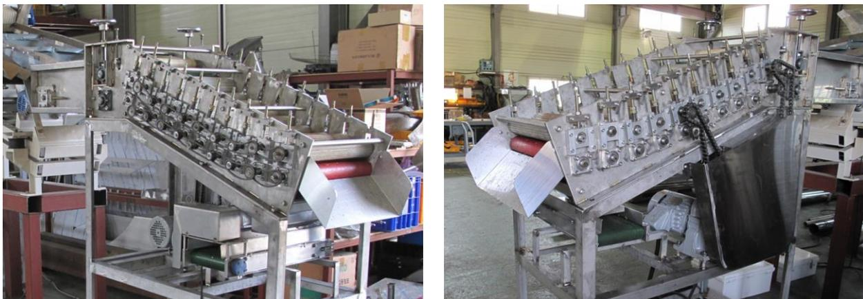
그림 105. 압축인장식 고추꼭지제거 장치 2차 시작품의 압축롤 및 실리콘롤 조합
