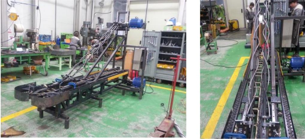
그림 2. 직경 60 mm의 helix를 장착한 탈실부 요인시험 장치
