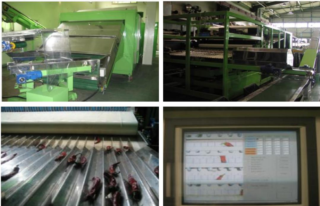
그림 25. 영상처리장치를 이용한 생고추 원료 꼭지제거 시스템(영월농협/생명과학기술, 2007. 10)
