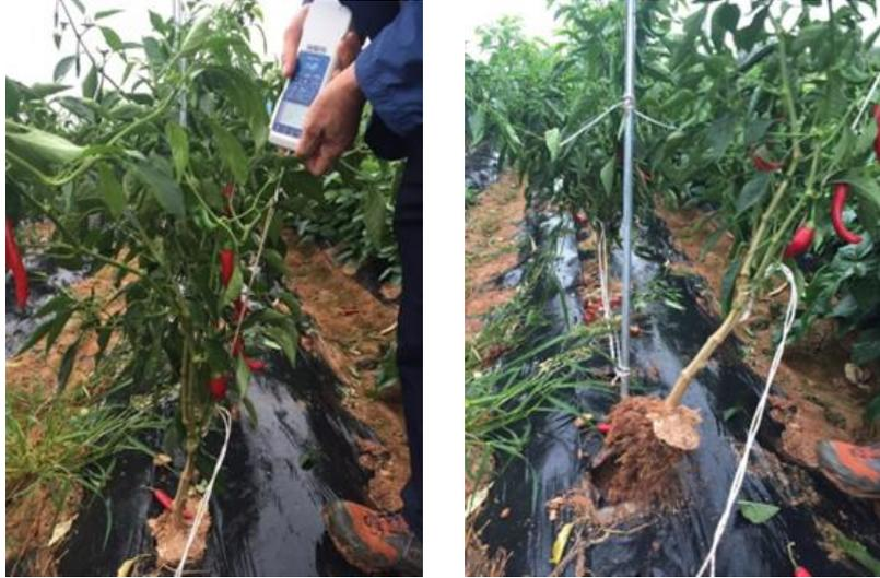
그림 62. 고추 식물체 인발력 측정 실험 모습 (나주)
