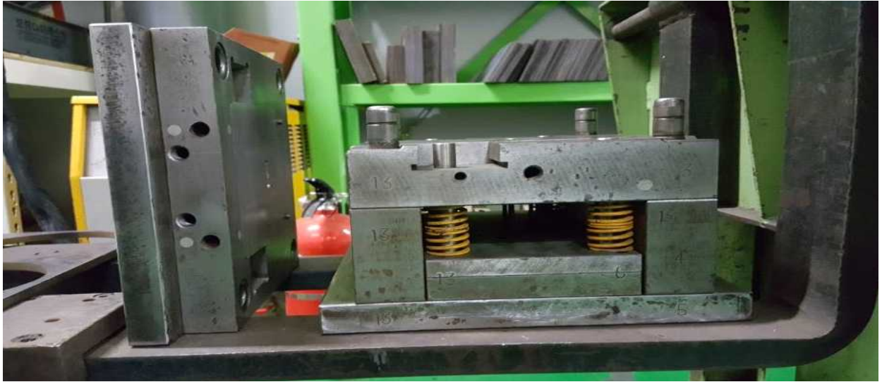
그림 31. 하우징 금형의 측면 사진.
