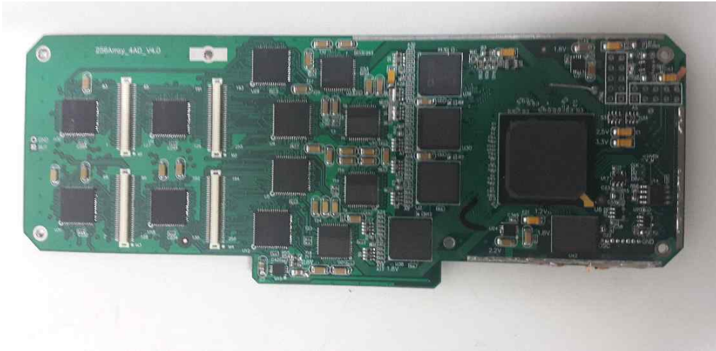
그림 18. 2차 시제품의 메인PCB 제작 사진.
