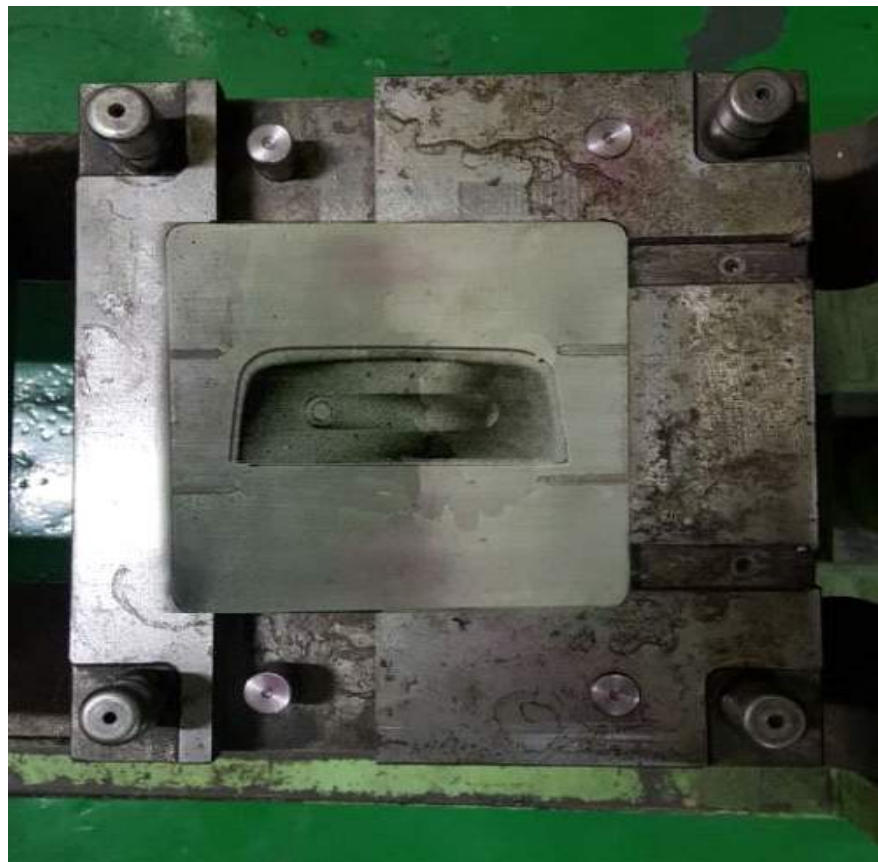
그림 32. 하우징 금형 정면 사진.
