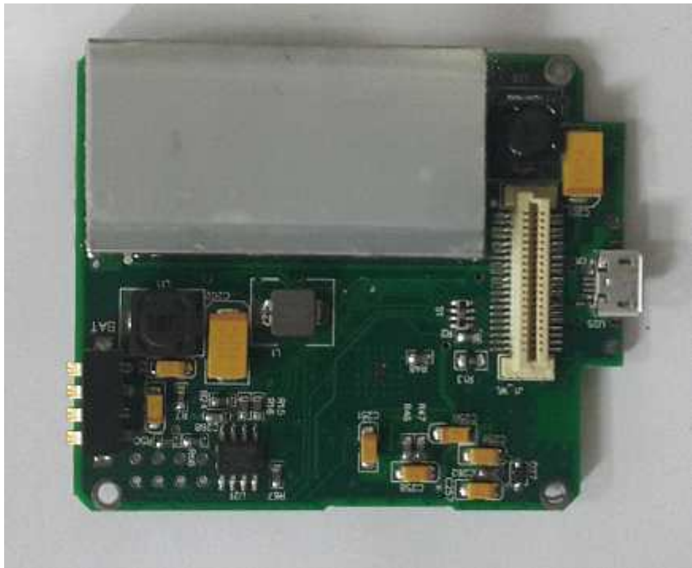
그림 6. 1차 시작품의 서브 PCB 제작 사진.
