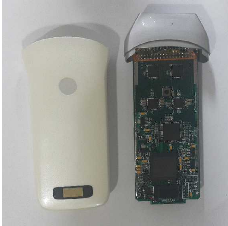
그림 10. 목업 하우징과 PCB 사진.
