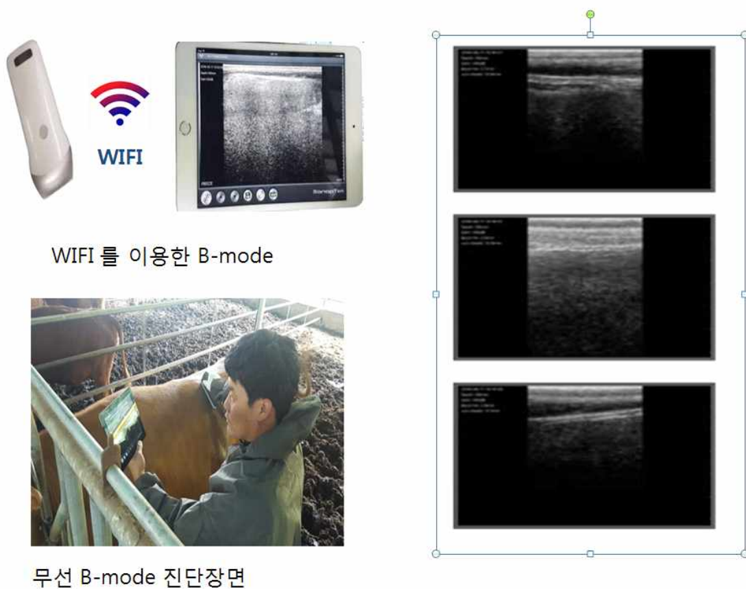
그림 2. Wi-Fi를 이용한 B-mode 초음파 개발 제품
