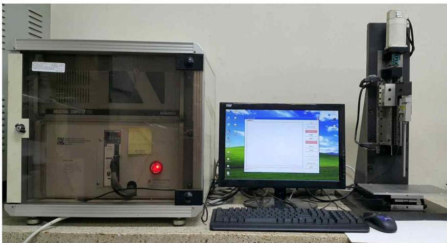
그림 3-18. 압축 응력 및 절단 시험을 위한 실험 장치
