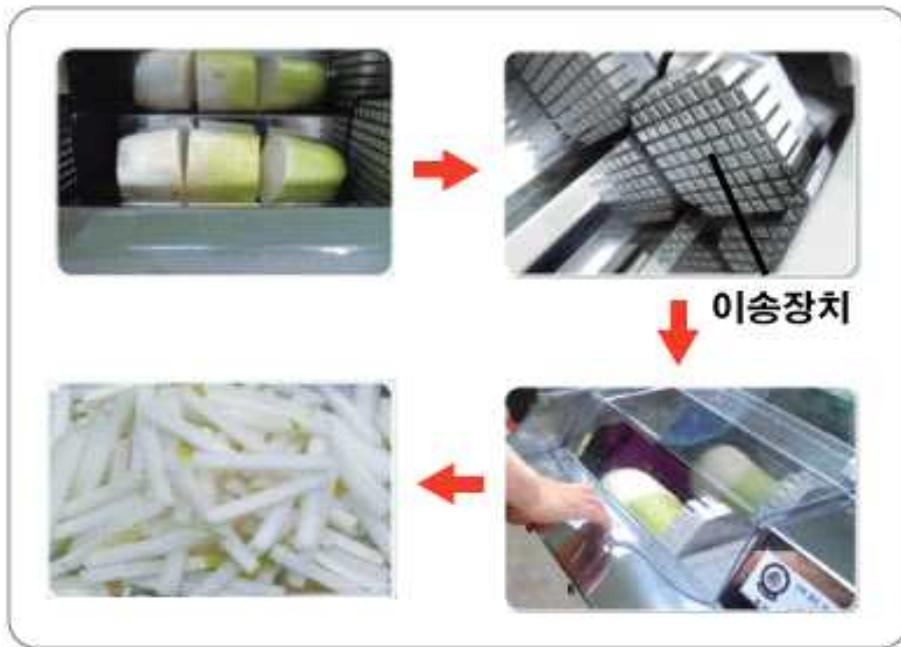
그림 3-13. 반자동 프레스 시스템
