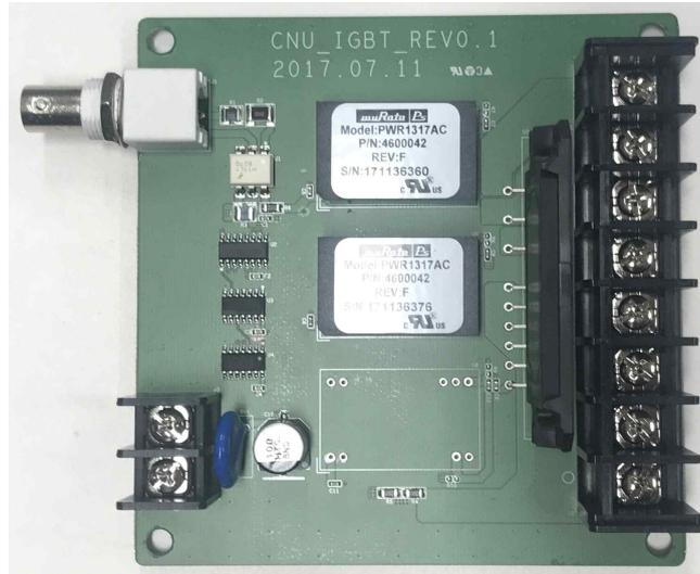
그림 3-51. 로직컨트롤러를 포함하는 IGBT 제어장치
