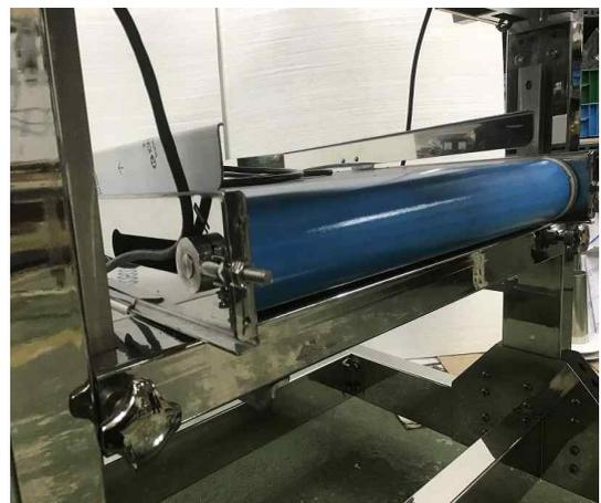
그림 3-45. 컨베이어 높낮이 슬라이드 장치 개발
