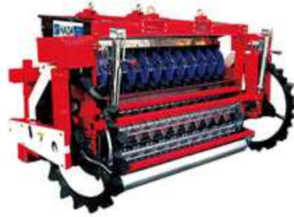
&lt;그림 4-1&gt; 경운기 부착형 및 트랙터 부착형 마늘 파종기
