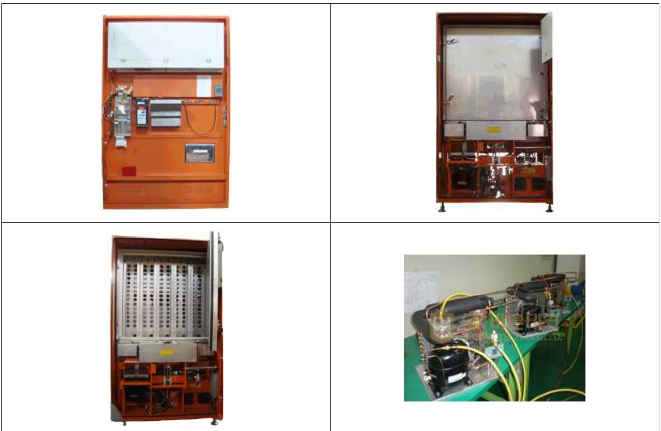
그림 1-2-4. 냉동상품 복원실험에 사용될 냉동자판기 외관 및 내부 구조
