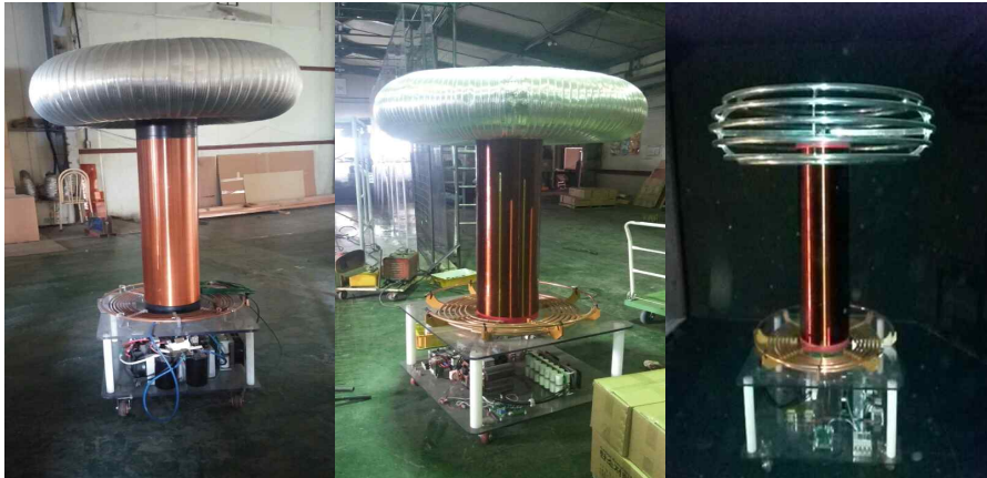
[그림 3]. 선광엘티아이(주)에서 개발한 SSTC 기반 대형 Tesla coil.
