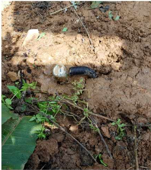
[그림 2.3.25] FDR 센서 설치
