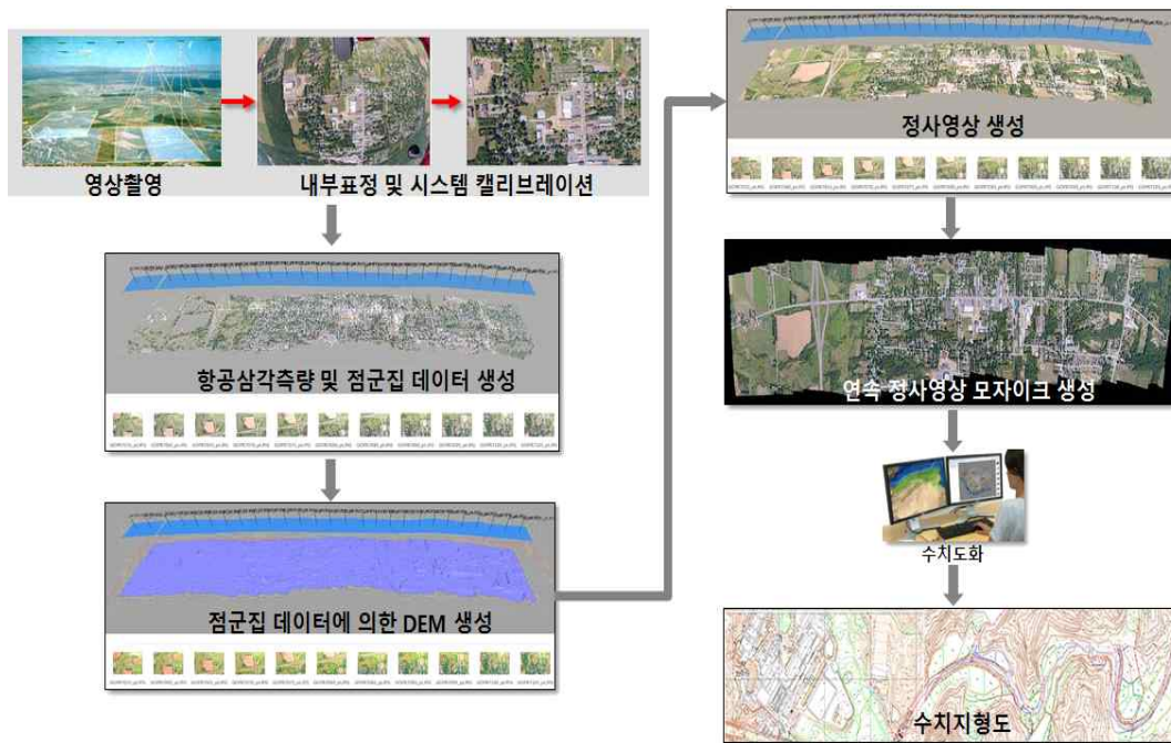
[그림 2.1.62] 드론 영상에 의한 수치지형도 제작 과정
