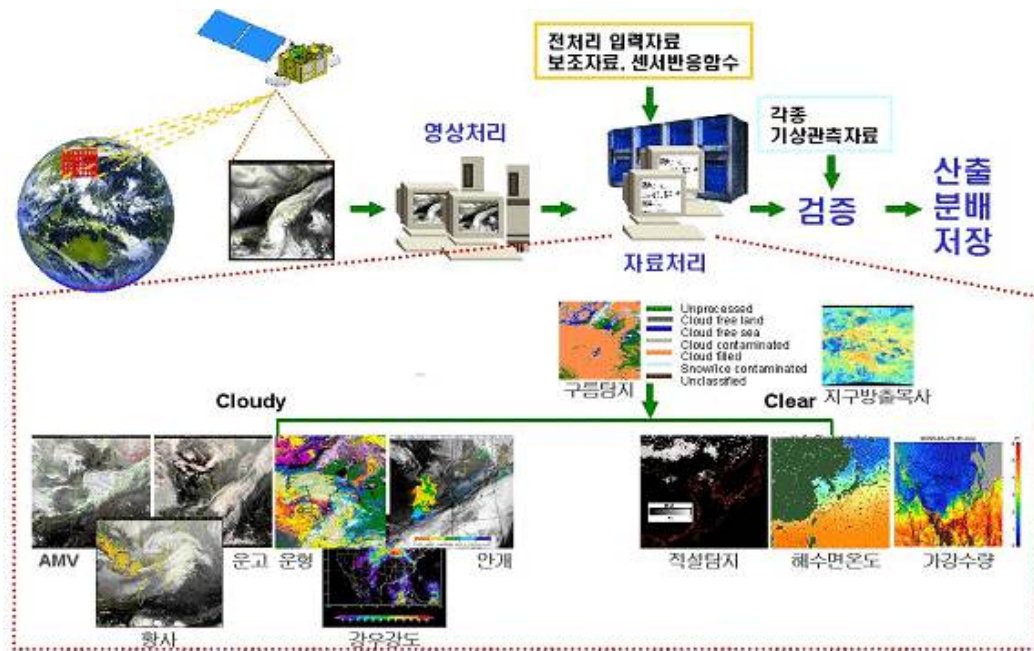
[그림 2.2.119] 기상자료처리시스템(CMDPS) 개념
