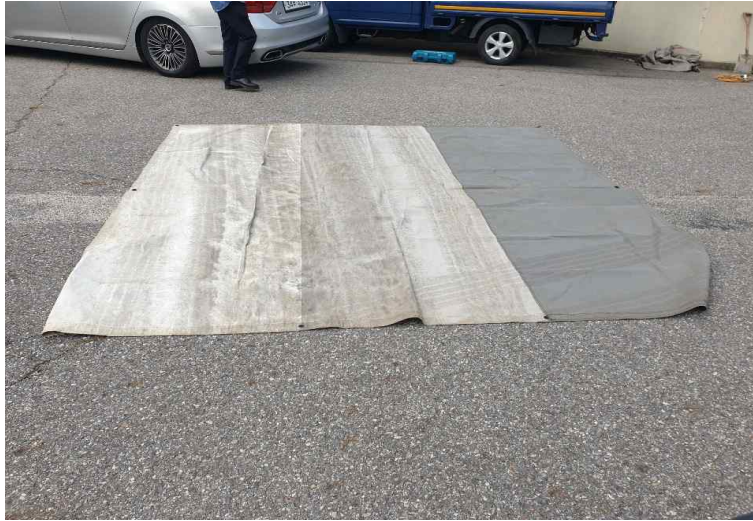
[그림 2.1.100] 방사보정을 위한 Traf 설치
