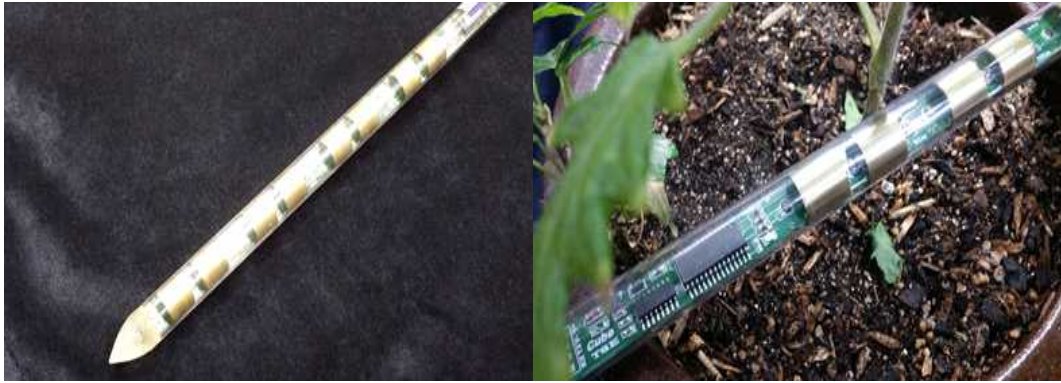
[그림 2.3.92] FDR 토양수분 및 온도 측정 장비 설치 및 장비 구조
