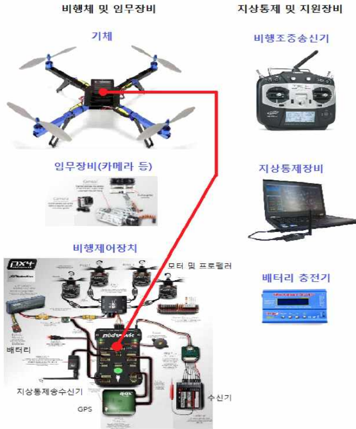
[그림 2.1.4] 소형 드론 구성 요소 (자료 : 한국산업은행 산은조사월보 제733호, “드론 기술현황 및 기술경쟁력 분석”, 2016)
