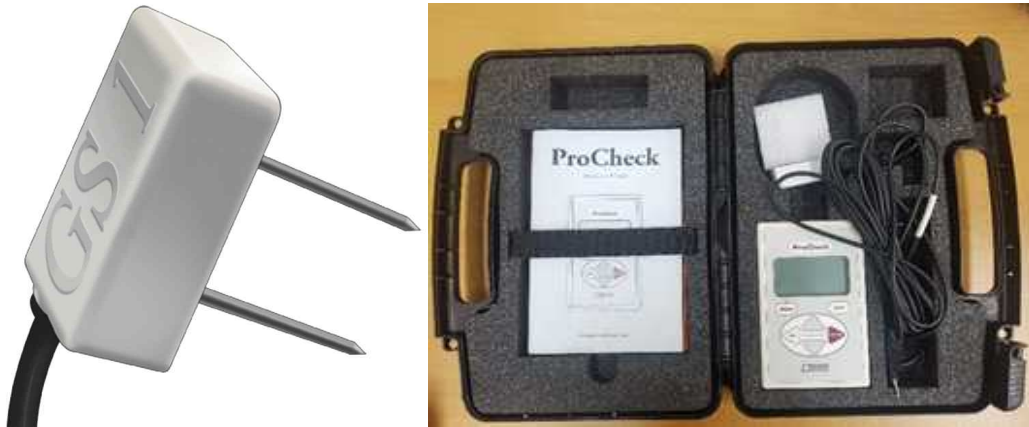
[그림 2.3.23] 토양수분측정 센서(GS-1)(좌) 및 출력장치(ProCheck)(우)
