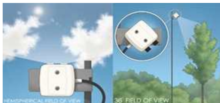
[그림 2.3.33] NDVI 센서 작동 모식도
