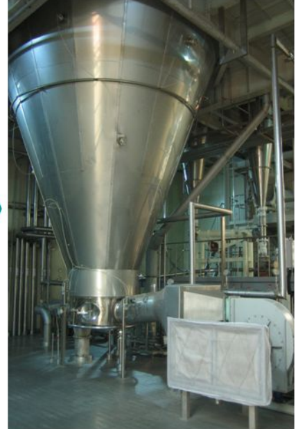
농축유청액(고창, TS 32) -> 유지방 제거(광주공장) -> 제균(HTST, 80°C 15초), 및 분말화(SD) 그림 3. 칼슘 킬레이팅 반응용 기질 단백질인 무지유청분말(제균) 생산공정
