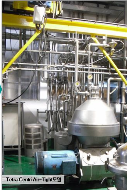
농축유청액(고창, TS 32) -> 유지방 제거(광주공장) -> 제균(HTST, 80°C 15초), 및 분말화(SD) 그림 3. 칼슘 킬레이팅 반응용 기질 단백질인 무지유청분말(제균) 생산공정
