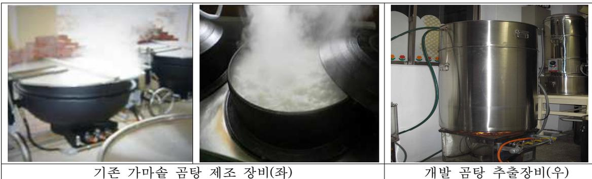
[그림 3] 수냉식 냉각장치를 탑재한 곰탕 추출/제조 장치 비교(좌 와 우)
