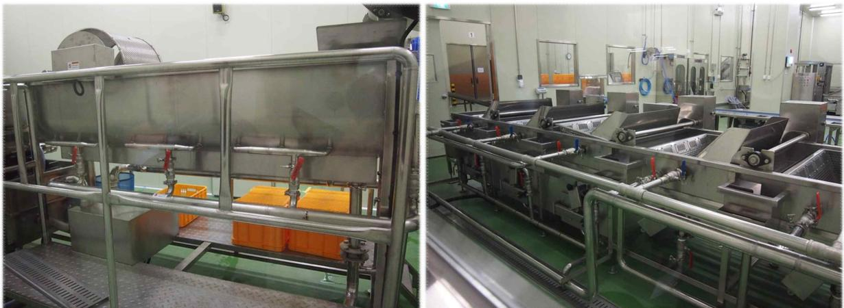
그림 36. 세척기 세척수 공급 및 배수용 배관 설치 사진
