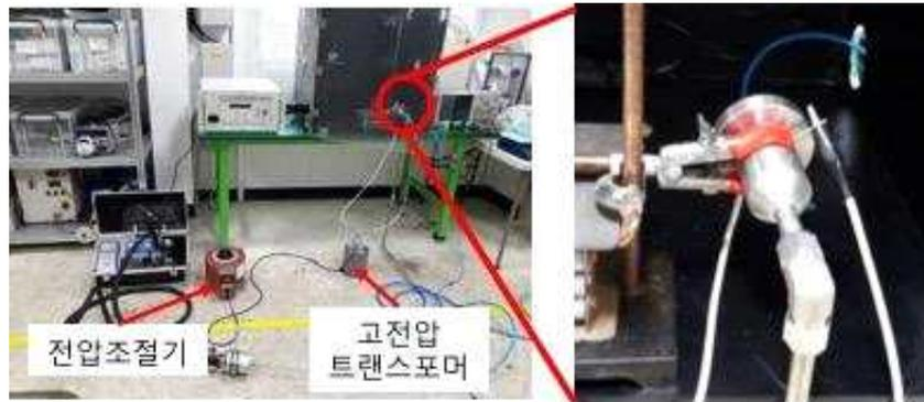
그림 146. Gliding arc 발생 시스템 사진
