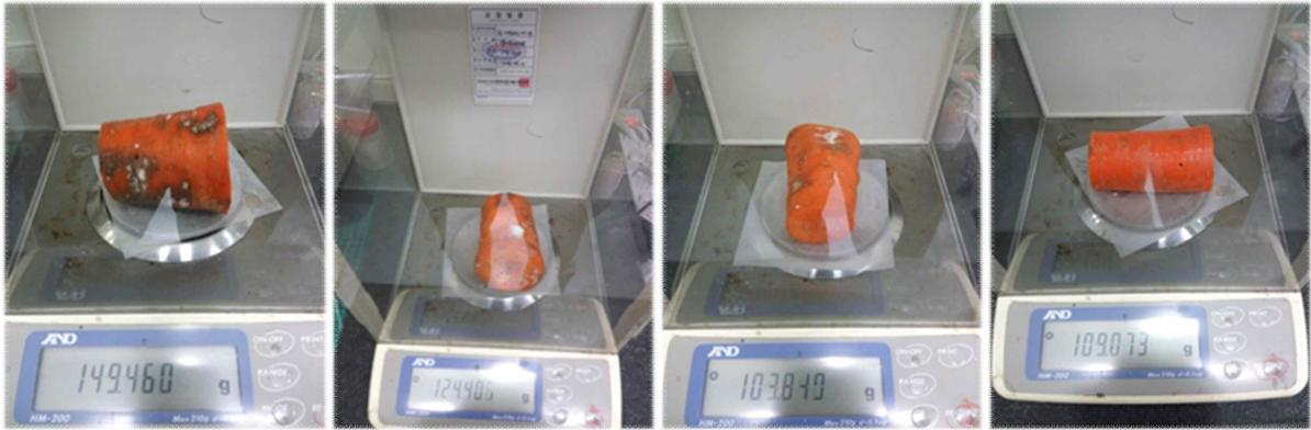
그림 28. 세척당근 가스 포집전 정량 (좌측부터 수돗물, 0.5mM H<sub>2</sub>O<sub>2</sub>, 1.0mM H<sub>2</sub>O<sub>2</sub>, 2.0mM H<sub>2</sub>O<sub>2</sub>)
