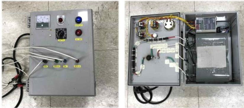
그림 152. 모듈화된 Gliding arc 전원공급장치의 사진
