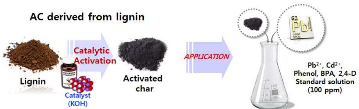
그림 40. 리그닌 유래 활성탄 제조 및 오염 물질 제거 실험 진행 과정 모식도
