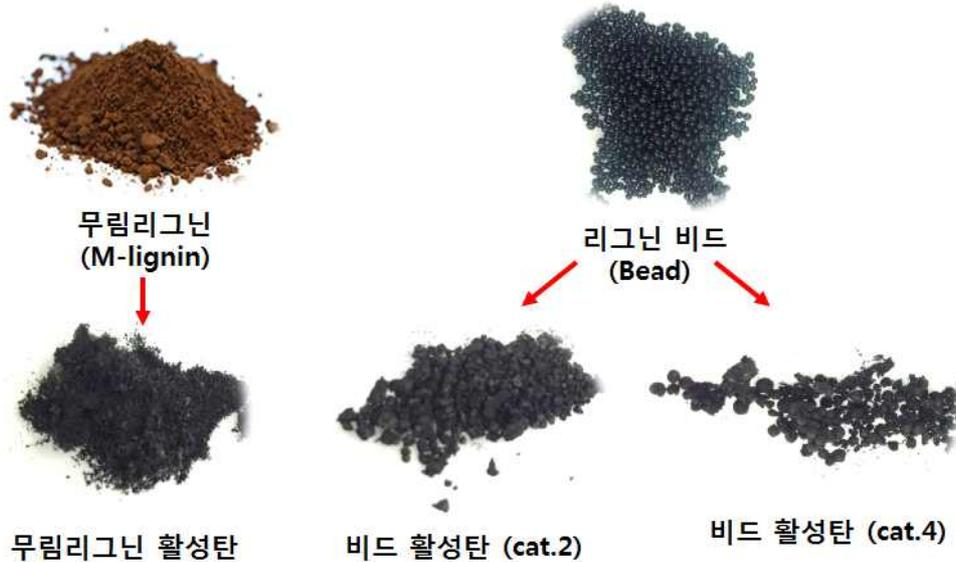
그림 48. 무림제지 리그닌과 리그닌 비드를 이용한 활성탄 제조
