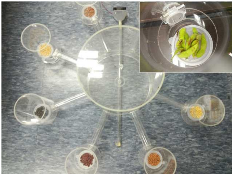
그림 13. 톱다리개미허리노린재의 섭식 선호성 조사를 위한 올팩토미터(olfactometer) 장치
