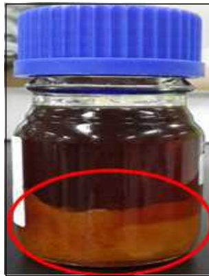
그림 115 1차반응 테스트 후 보관테스트 결과 : 침전물 발생
