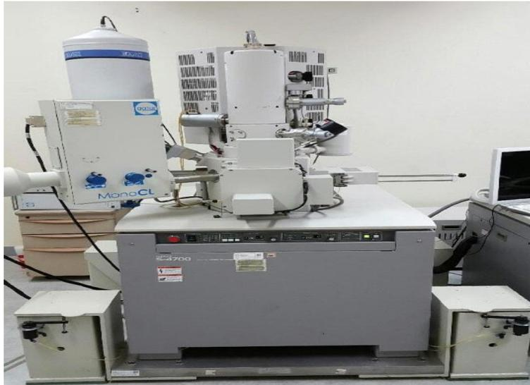
그림 12. 주사전자현미경을 이용한 표면구조분석
