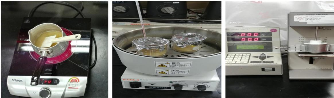
그림 28. Texture analyzer를 이용한 경도 측정
