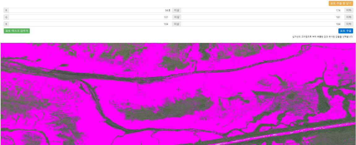
경계값 지정 및 십자선을 이용한 표토 추출 과정
