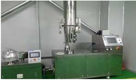
Fig. 2. 유동층건조과립기 및 타정기.
